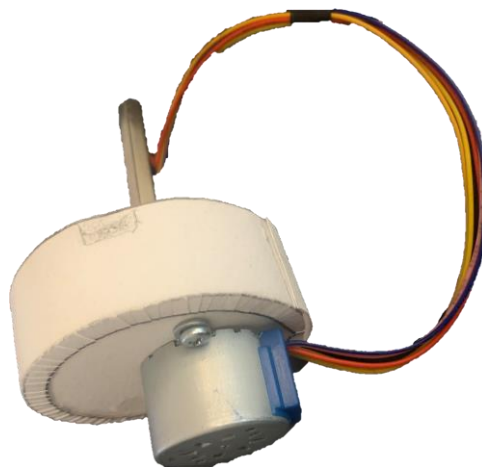
Εικόνα 15: Μηχανισμός περιστροφής τμημάτων φαρμακευτικών αγωγών
