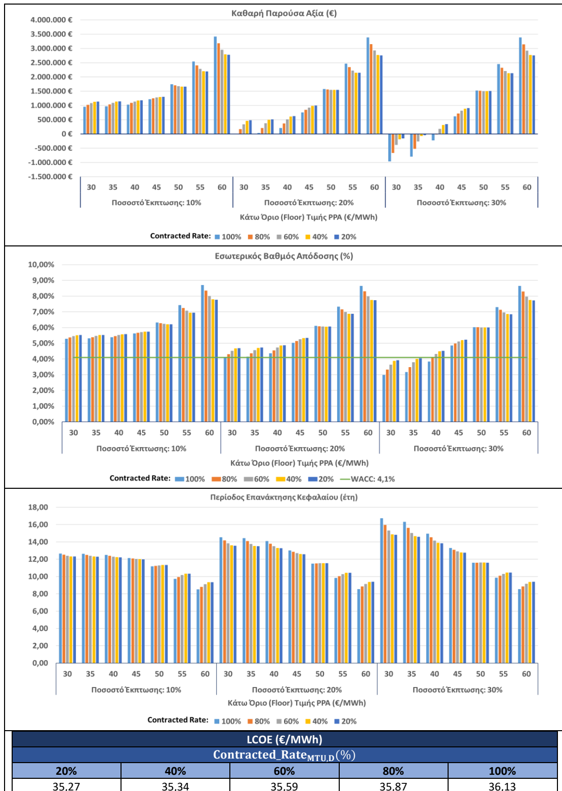
Εικόνα 27: Σενάριο 8 – Έκπτωση επί της Χονδρικής Τιμής ΗΕ και Παράλληλη Υπαρξη Κάτω Ορίου για την Τιμή PPA & Pay-As-Produced με Υποχρέωση Παράδοσης Ελάχιστης Ποσότητας ΗΕ (Φ/Β)
