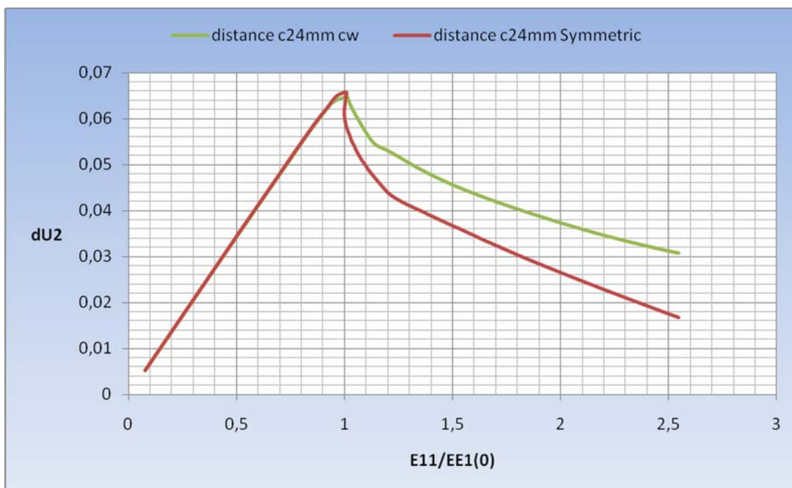
Σχήμα 7.45 Διακύμανση διαστήματος πλάτυνσης με ρωγμή c=24mm και c_w=4.9mm
