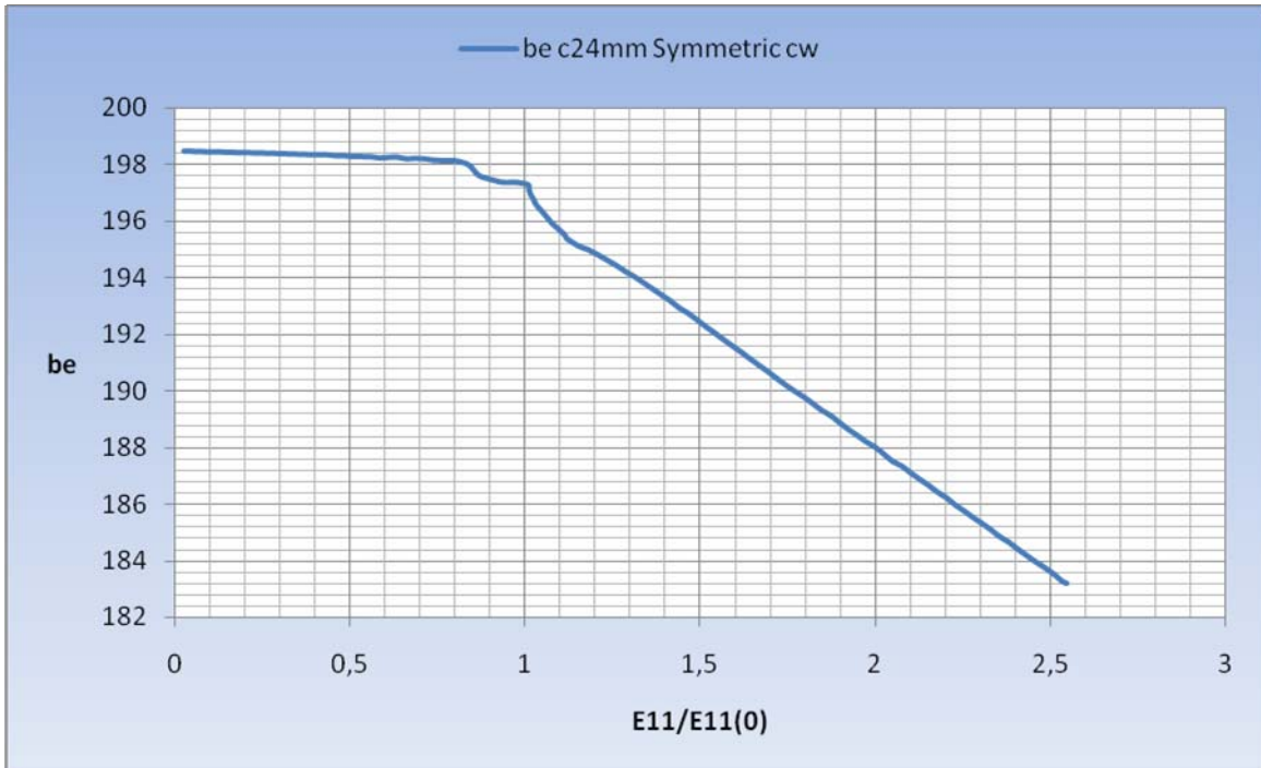
Σχήμα 7.40 Διακύμανση συνολικού ισοδύναμου πλάτους για ρωγμή συμμετρική c=24mm/c_w=4.9mm
