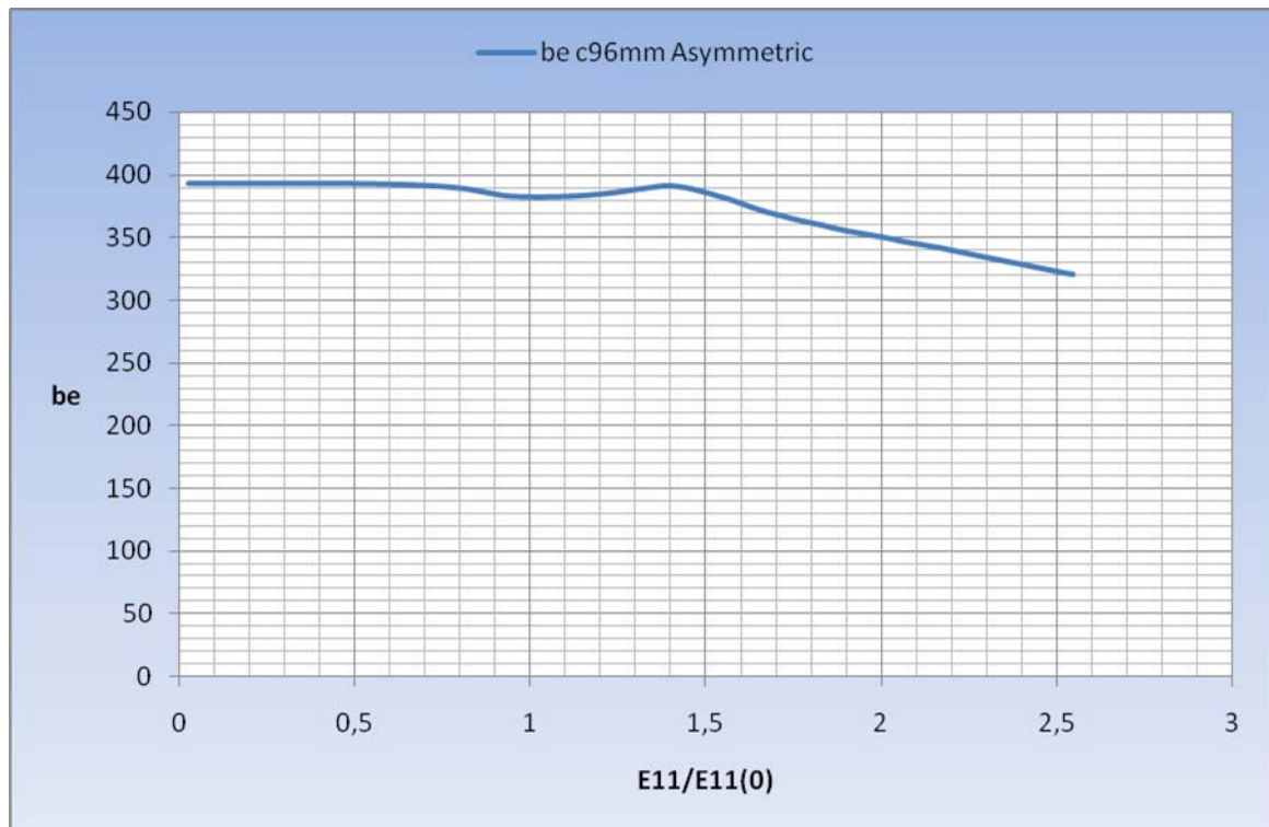
Σχήμα 6.66 Διακύμανση ισοδύναμου πλάτους a/b=1.5 με c=96\text{mm} ασύμμετρη
