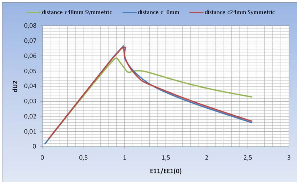
Σχήμα 7.37 Διακύμανση διαστήματος πλάτυνσης άνευ/ με ρωγή c=24/48mm
