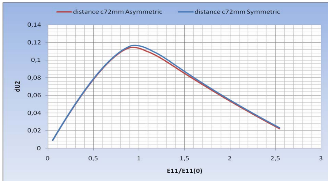
Σχήμα 5.60 Σύγκριση των διαστημάτων πλάτυνσης για τα μοντέλα με συμμετρική/ ασύμμετρη ρωγμή c=72mm στην πλάκα.
