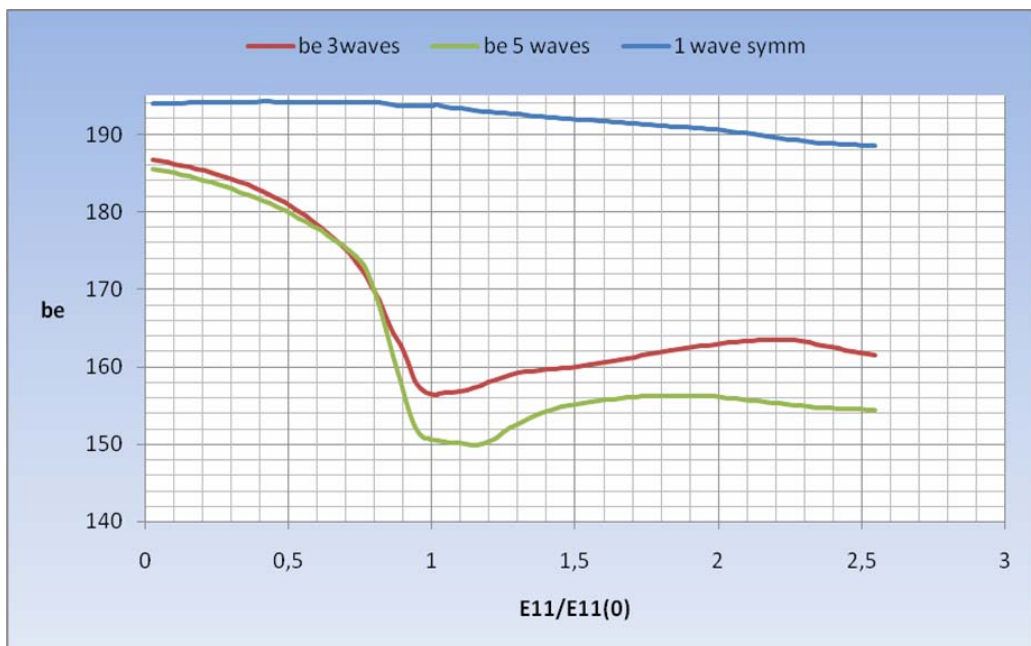
Σχήμα 7.15 Διακύμανση συνολικών ισοδύναμων πλατών με n=1,3,5 (antisymm)
