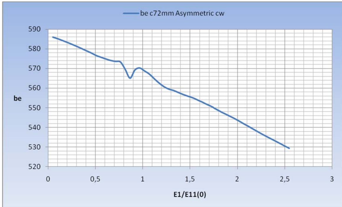
Σχήμα 5.73 Διακύμανση του συνολικού ισοδύναμου πλάτους για ενισχυμένο έλασμα με ρωγμή c=72mm στην πλάκα και επιπλέον ρωγμή στο ενισχυτικό cw=14.7mm
