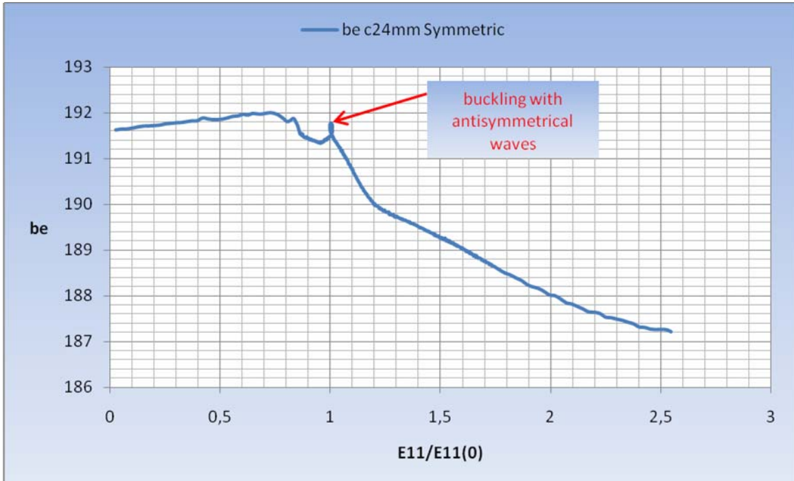
Σχήμα 7.23 Διακύμανση συνολικού ισοδύναμου πλάτους για ρωγμή c=24\text{mm}
