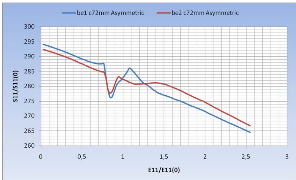
Σχήμα 5.59 Διακύμανση των ισοδύναμων πλατών για ενισχυμένο έλασμα με ρωγμή c=72mm στο ένα τμήμα της πλάκας
