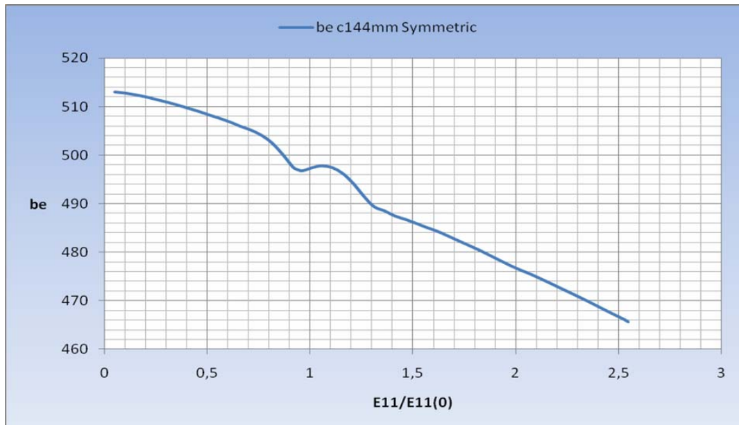
Σχήμα 5.33 Διακύμανση του συνολικού ισοδύναμου πλάτους για το ενισχυμένο έλασμα με συμμετρική ρωγμή c=144mm
