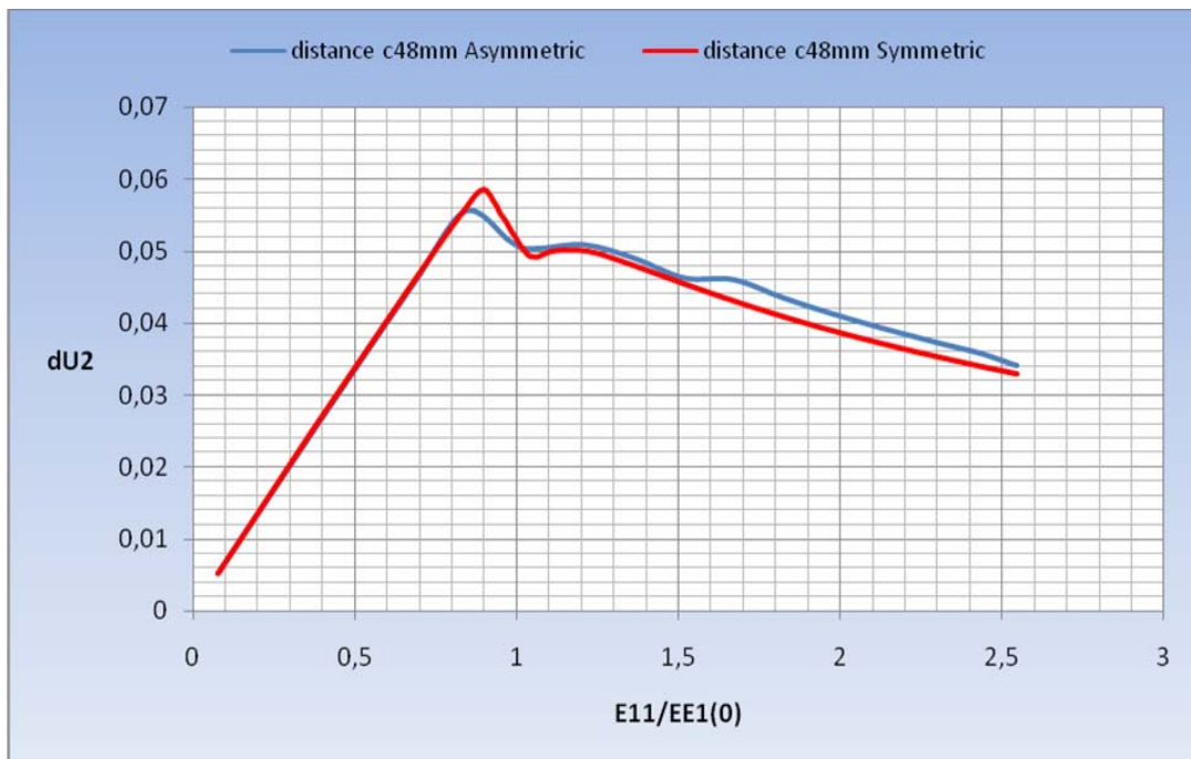
Σχήμα 7.69 Διακύμανση διαστήματος πλάτυνσης με ασύμμετρη ρωγμή c=48mm
