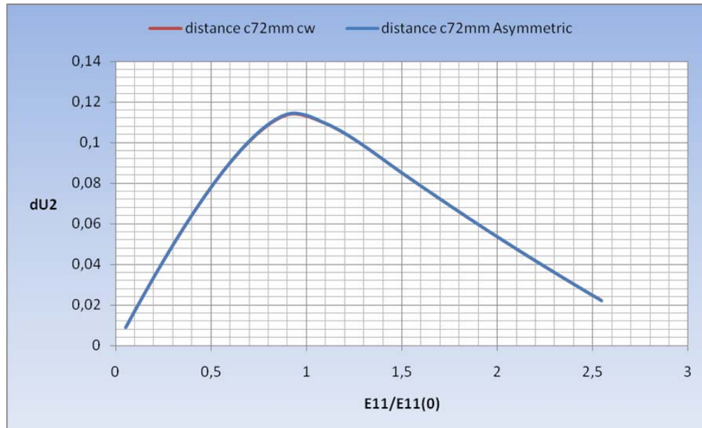
Σχήμα 5.77 Σύγκριση των διαστημάτων πλάτυνσης για τα μοντέλα με χωρίς/ με ρωγμή ενισχυτικού
