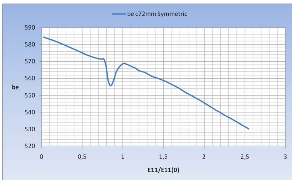
Σχήμα 5.27 Διακύμανση του συνολικού ισοδύναμου πλάτους για το ενισχυμένο έλασμα με συμμετρική ρωγμή c=72mm
