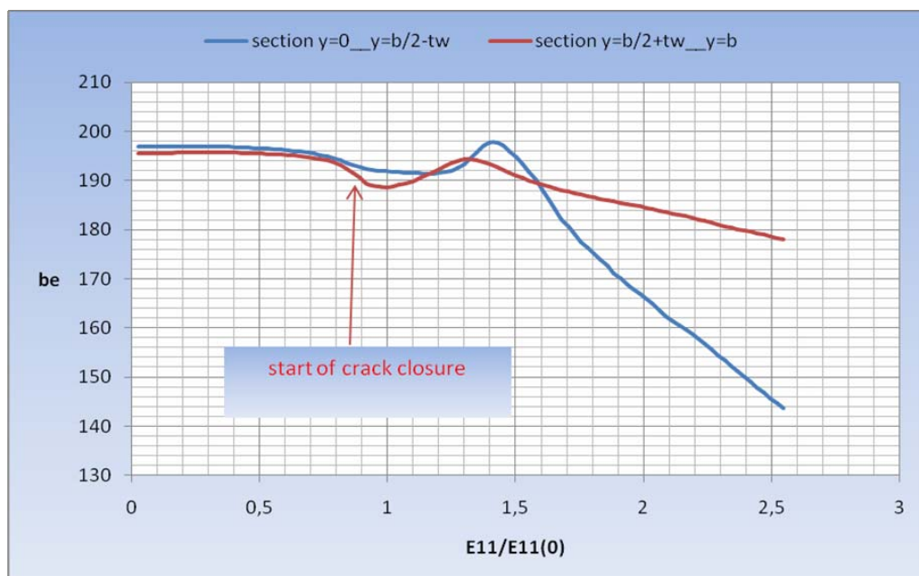
Σχήμα 6.83 Διακύμανση ισοδύναμου πλάτους στα δύο τμήματα της πλάκας
