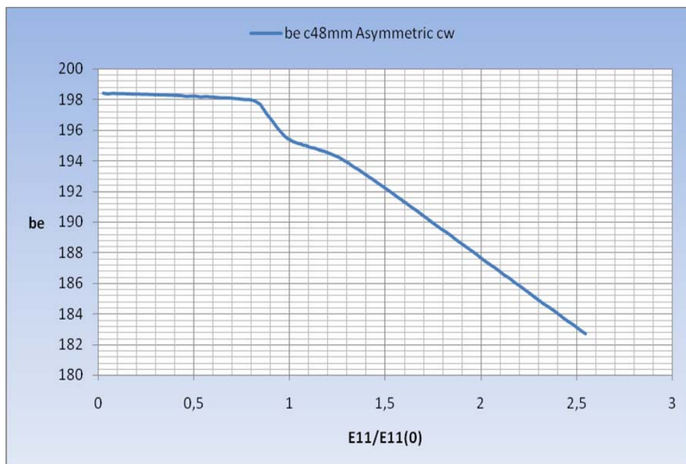
Σχήμα 7.80 Διακύμανση συνολικού ισοδύναμου πλάτους για ρωγμή ασύμμετρη c=48mm και επιπλέον ρωγμή c_w=4.9mm στο ενισχυτικό.
