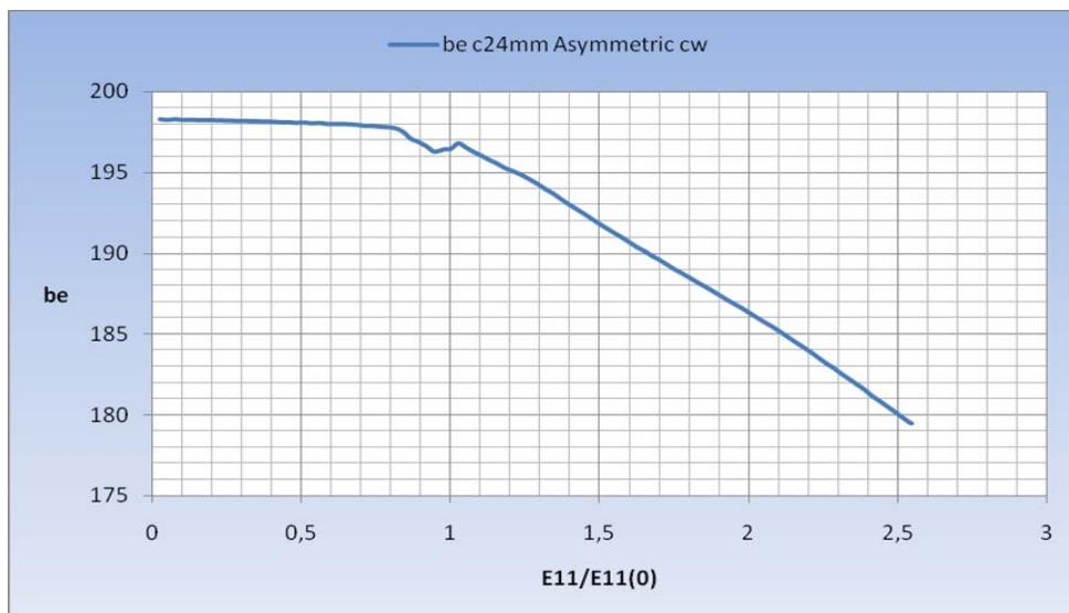
Σχήμα 7.72 Διακύμανση συνολικού ισοδύναμου πλάτους για ρωγμή ασύμμετρη c=24mm και επιπλέον ρωγμή c_w=4.9mm στο ενισχυτικό.
