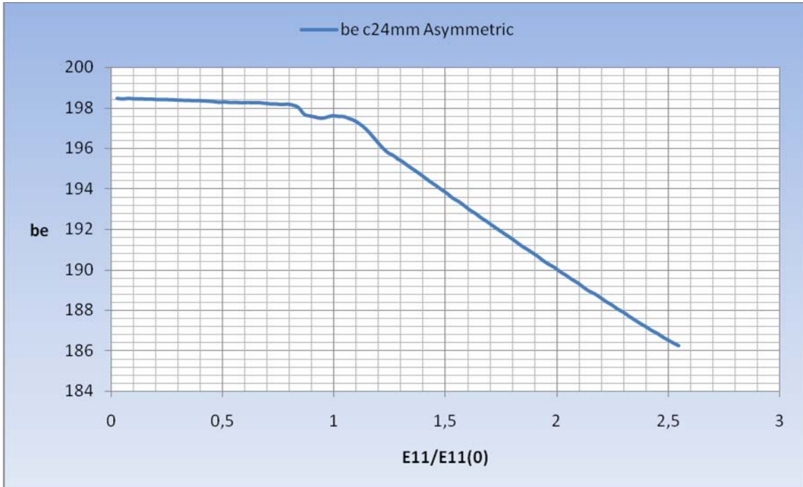
Σχήμα 7.56 Διακύμανση συνολικού ισοδύναμου πλάτους για ρωγμή ασύμμετρη c=24mm
