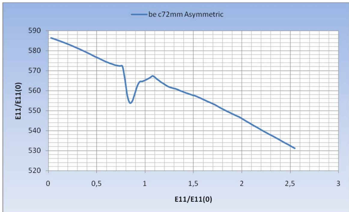
Σχήμα 5.58 Διακύμανση του συνολικού ισοδύναμου πλάτους για ενισχυμένο έλασμα με ρωγμή c=72mm στο ένα τμήμα της πλάκας
