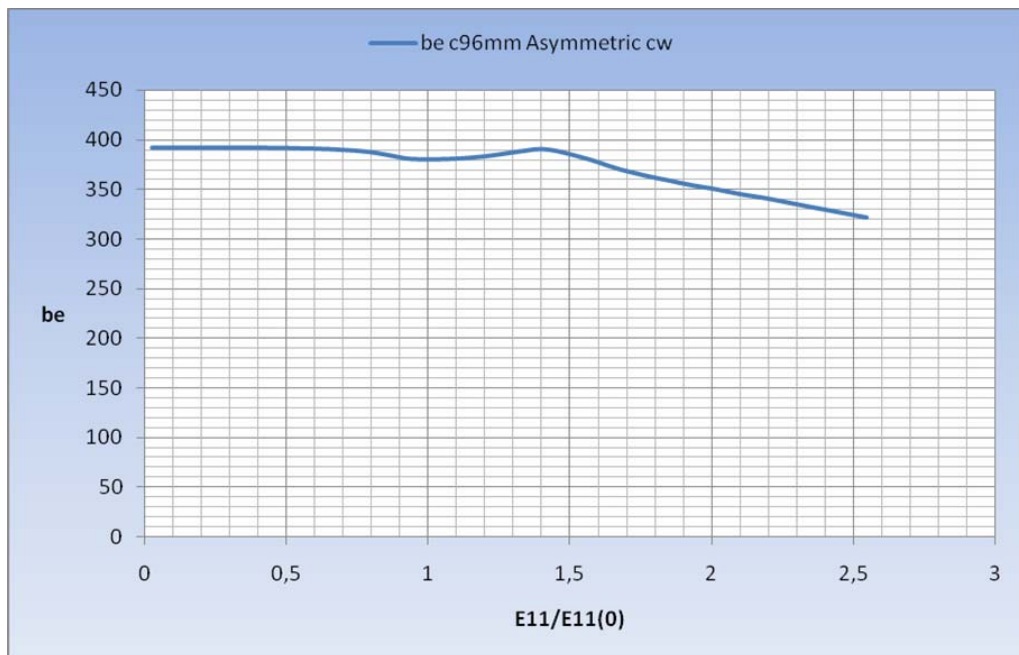
Σχήμα 6.82 Διακύμανση ισοδύναμου πλάτους a/b=1.5 με ασύμμετρη c=96mm στην πλάκα και επέκταση ρωγμής στο ενισχυτικό c_w=9.798mm
