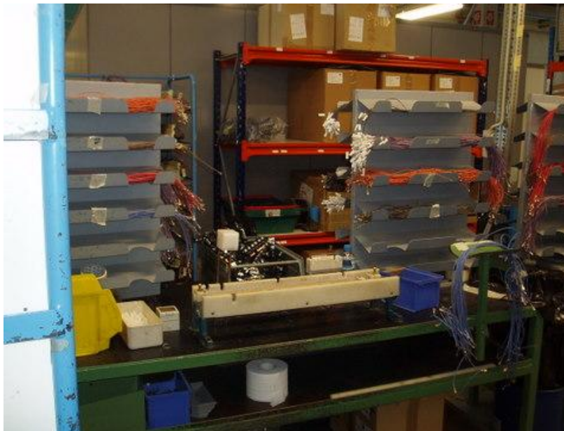
Εικόνα 6.3 τελική φάση συναρμολόγησης - τοποθέτηση καλωδιώσεων
