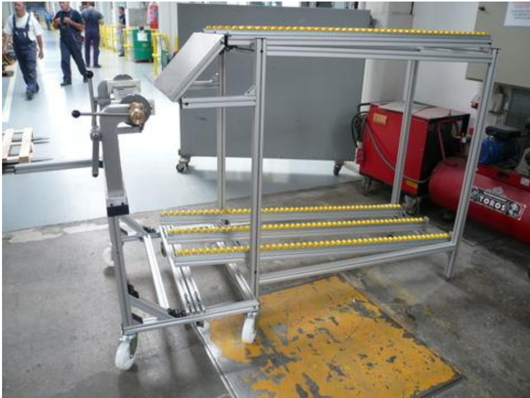
Εικόνα 7.2 Ειδικό καρότσι συναρμολόγησης ως προς ραφιέρα
