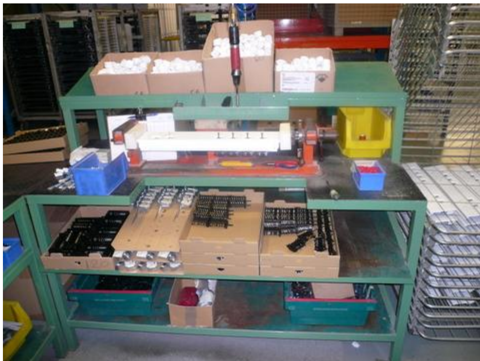
Εικόνα 6.1 θέση στην οποία σταθεροποιείται ο πίνακας διακοπών προκειμένου να πραγματοποιηθεί η συναρμολόγηση
