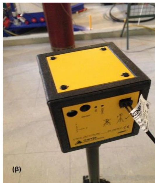
Εικόνα 4.2: Αισθητήρες (α) Μαγνητικού και (β) Ηλεκτρικού Πεδίου.
