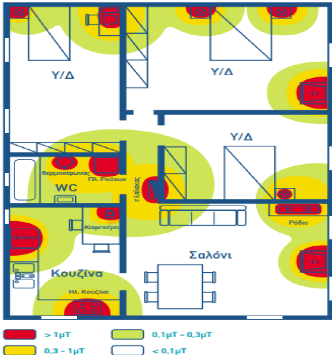
Σχήμα 2.2: Τυπικά επίπεδα μαγνητικού πεδίου από οικιακές ηλεκτρικές συσκευές [3]. Ακολούθως παρατίθεται πίνακας με τις ηλεκτρικές συσκευές και τα τυπικά επίπεδα μαγνητικού πεδίου.
