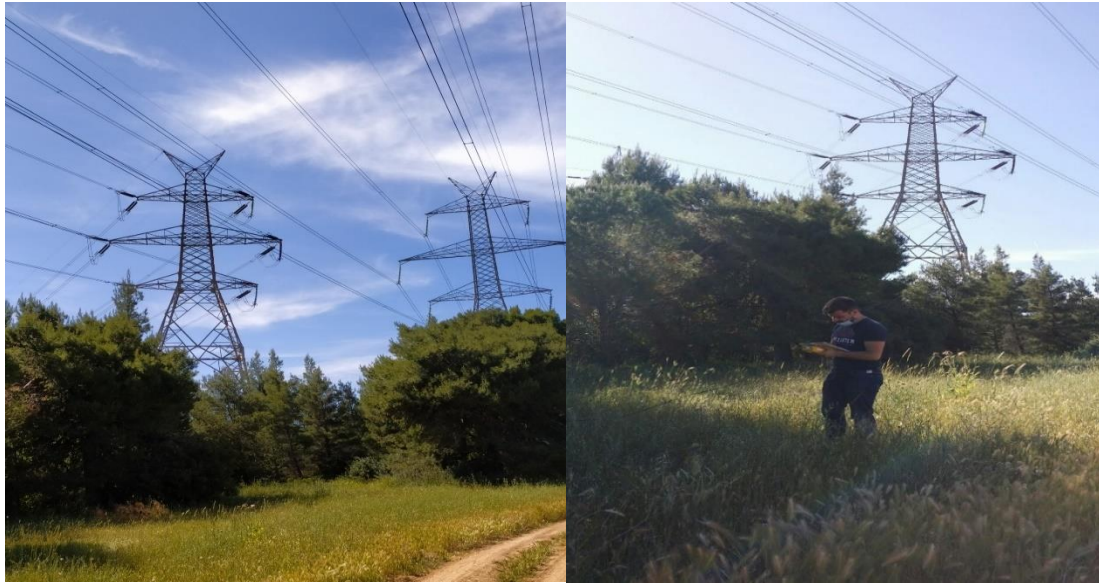
Εικόνα 6.7: Μέτρηση ηλεκτρικού πεδίου στον εγκάρσιο άξονα που απέχει 150 m από το μέσον των Πυλώνων ΑΡΚ 59 και ΚΛΣ 54.
