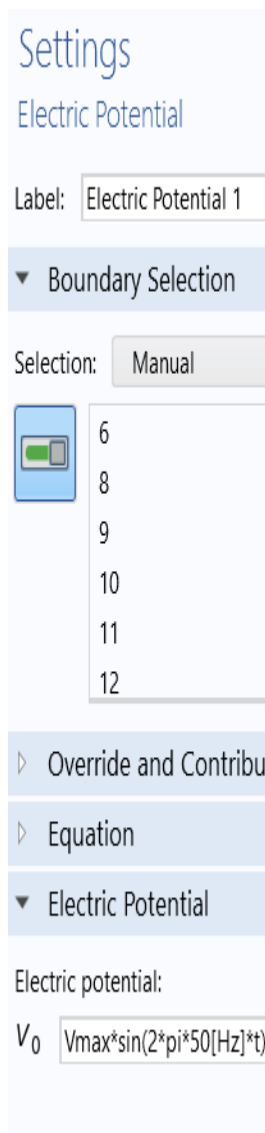
Εικόνα 7.19: Electric Potential 1 (Φάση 1) COMSOL.
