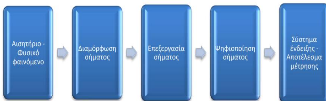
Σχήμα 4.1: Σχηματική συνήθης δομή μετρητικών διατάξεων.
