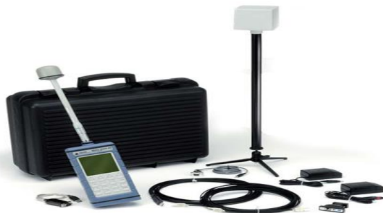
Εικόνα 4.4: Πεδίομετρο PWM 8053A και όλος ο εξοπλισμός.
