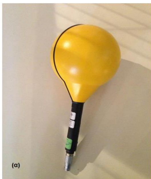
Εικόνα 4.2: Αισθητήρες (α) Μαγνητικού και (β) Ηλεκτρικού Πεδίου.
