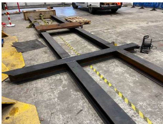
Εικόνα 23: Πειραματική διάταξη για την ολίσθηση 1.5 τόνου (βάρους συσσωρευτή) με τις εναλλακτικές λύσεις που προτιμήθηκαν. Πηγή: Φωτογραφία του συγγραφέα κατά την πρακτική του στο CERN.
