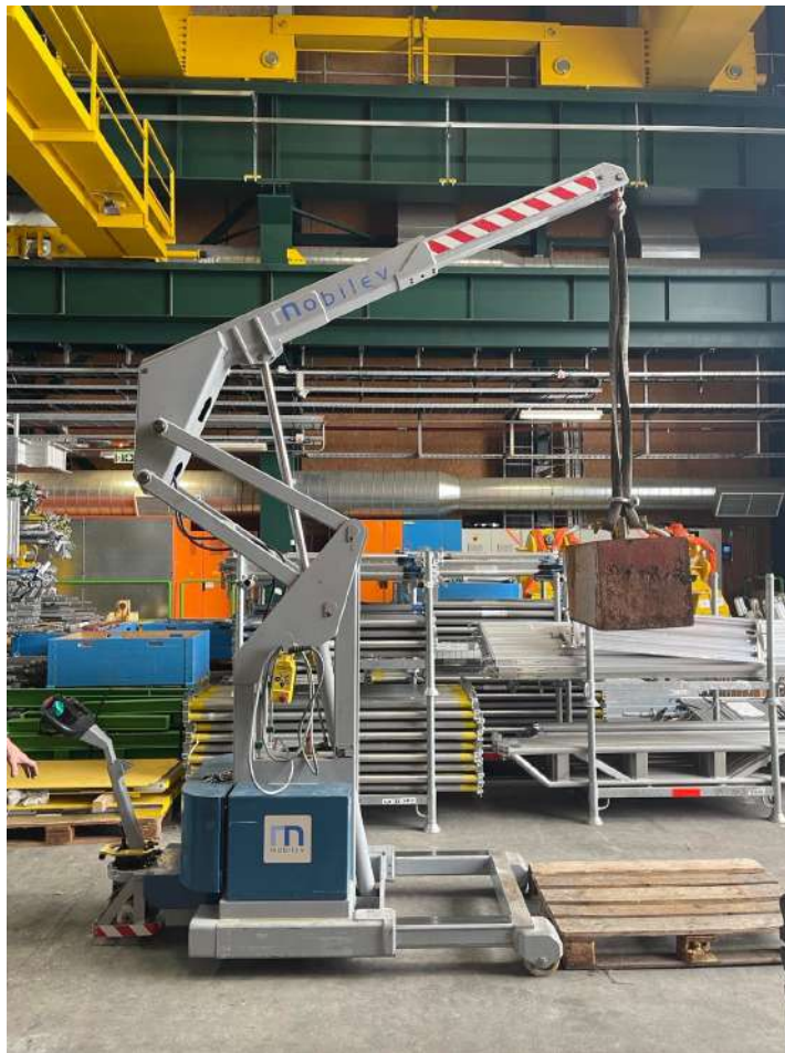
Εικόνα 69: Πειραματική διαδικασία ανύψωσης χαλύβδινου μπλοκ ενός τόνου με τον κινητό τηλεσκοπικό γερανό. Πηγή: Φωτογραφία του συγγραφέα κατά την πρακτική του στο CERN.
