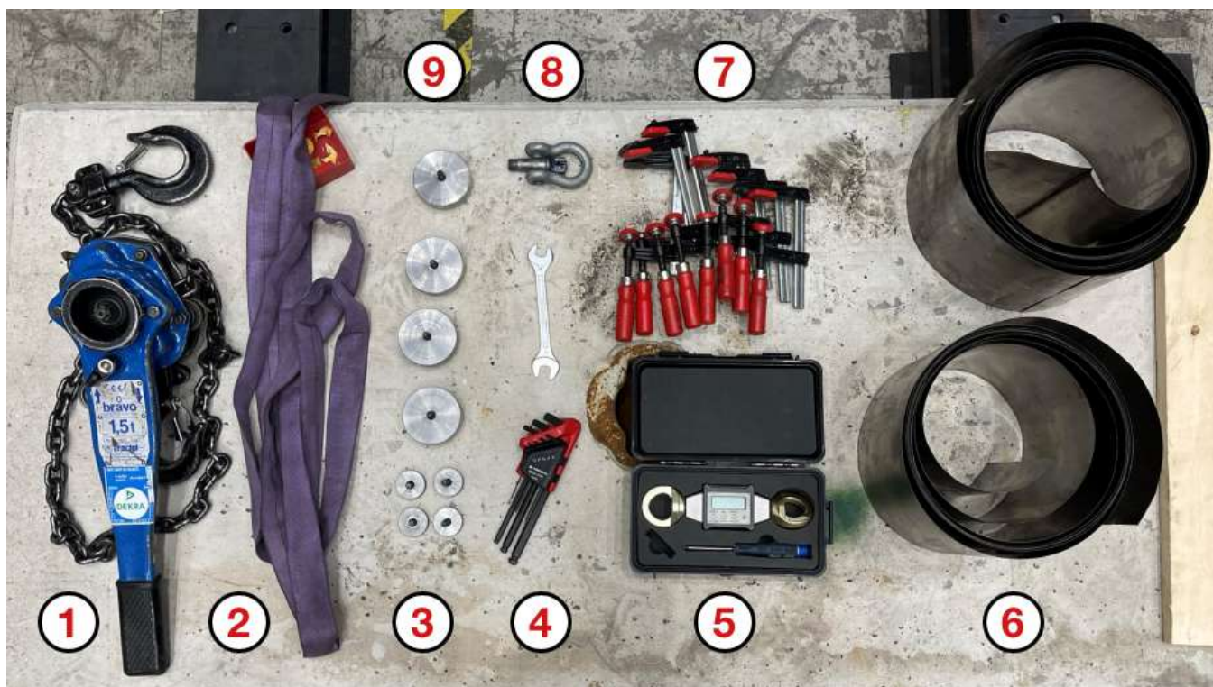
Εικόνα 26: Εξοπλισμός για την διεξαγωγή του πειράματος ολίσθησης: 1. Παλάγκο ενάμιση τόνου, 2. Υφασμάτινοι ιμάντες φορτίου δύο τόνων, 3. Διεπαφές Permaglide®, 4. Εξοπλισμός συναρμολόγησης (γαλλικά και εξαγωνικά κλειδιά), 5. Δυναμόμετρο, 6. Φύλλα ανοξείδωτου χάλυβα, 7. Σφιγκτήρες τύπου F, 8. Ναυτικά κλειδιά. Πηγή: Φωτογραφία του συγγραφέα κατά την πρακτική του στο CERN
