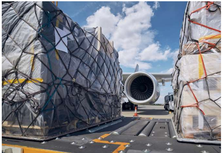
Εικόνα 9: Χρήση μονάδων μεταφοράς με σφαίρα (ball transfer units) για την μεταφορά εμπορευμάτων στα αεροδρόμια. Πηγή: https://www.lutco.com/ball-transfer-units-when-and-where-they-perform-best/
