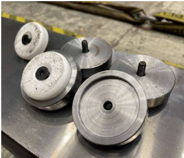
Εικόνα 25: Οι διεπαφές από PTFE (αριστερά) και Permaglide® (δεξιά) για τον έλεγχο των δύο εναλλακτικών λύσεων. Πηγή: Φωτογραφίες του συγγραφέα κατά την πρακτική του στο CERN.
