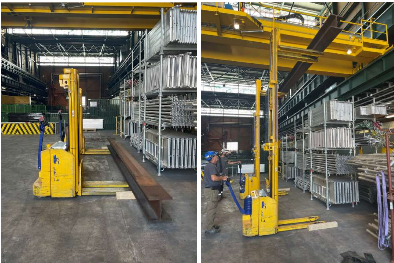
Εικόνα 67: Πειραματική διαδικασία ανύψωσης δοκού υπερυψωμένου γερανού με την ταυτόχρονη χρήση δύο στάκερ. Πηγή: Φωτογραφία του συγγραφέα κατά την πρακτική του στο CERN.
