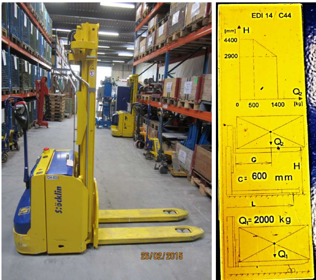
Εικόνα 65: Φωτογραφία του ηλεκτρικού στάκερ που χρησιμοποιήθηκε και διάγραμμα της ανυψωτικής του ικανότητας. Πηγή: CERN.
