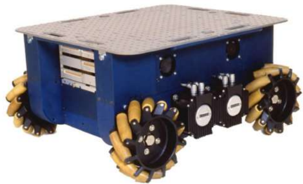
Εικόνα 21: Τυπική μορφή πανκατευθυντικού τροχού (omnidirectional wheel) και παράδειγμα εφαρμογής του στο χώρο της ρομποτικής. Πηγή: https://www.casterbot.com/p/4-inch-heavy-duty-mecanum-wheel-100mm-industrial-wheels/ και https://automaticaddison.com/force-vector-diagrams-for-an-omni-directional-mobile-robot/
