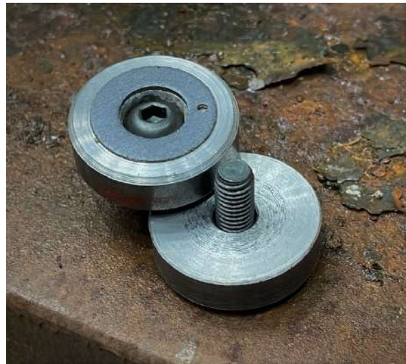
Εικόνα 25: Οι διεπαφές από PTFE (αριστερά) και Permaglide® (δεξιά) για τον έλεγχο των δύο εναλλακτικών λύσεων. Πηγή: Φωτογραφίες του συγγραφέα κατά την πρακτική του στο CERN.
