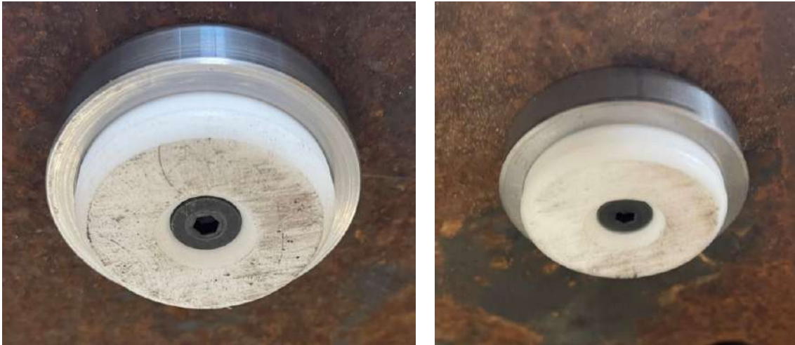
Εικόνα 27: Μικρή φθορά των διεπαφών PTFE: Μικρογρατζουνιές και λέρωμα πριν και μετά το τρίψιμο με νωπό πανί. Πηγή: Φωτογραφία του συγγραφέα κατά την πρακτική του στο CERN.
