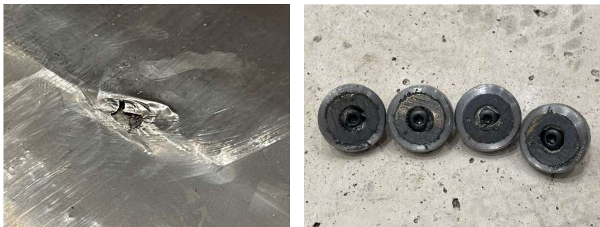
Εικόνα 29: Τα αποτελέσματα του τρίτου σεναρίου του πειράματος ολίσθησης κατά την διασταύρωση των προφίλ ΗΕΒ: Σχισμένο φύλλο ανοξείδωτου χάλυβα (αριστερά) και εκτεταμένη φθορά στις ροδέλες Permaglide® (δεξιά). Πηγή: Φωτογραφία του συγγραφέα κατά την πρακτική του στο CERN.
