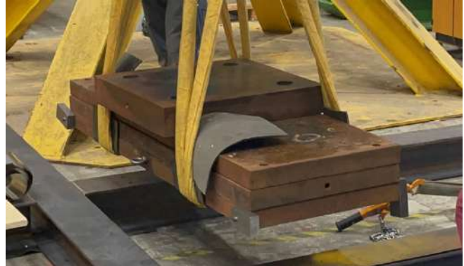
Εικόνα 24: Χαλύβδινες πλάκες συνολικού βάρους 1500 κιλών για την προσομοίωση του βάρους του συσσωρευτή. Πηγή: Φωτογραφία του συγγραφέα κατά την πρακτική του στο CERN.
