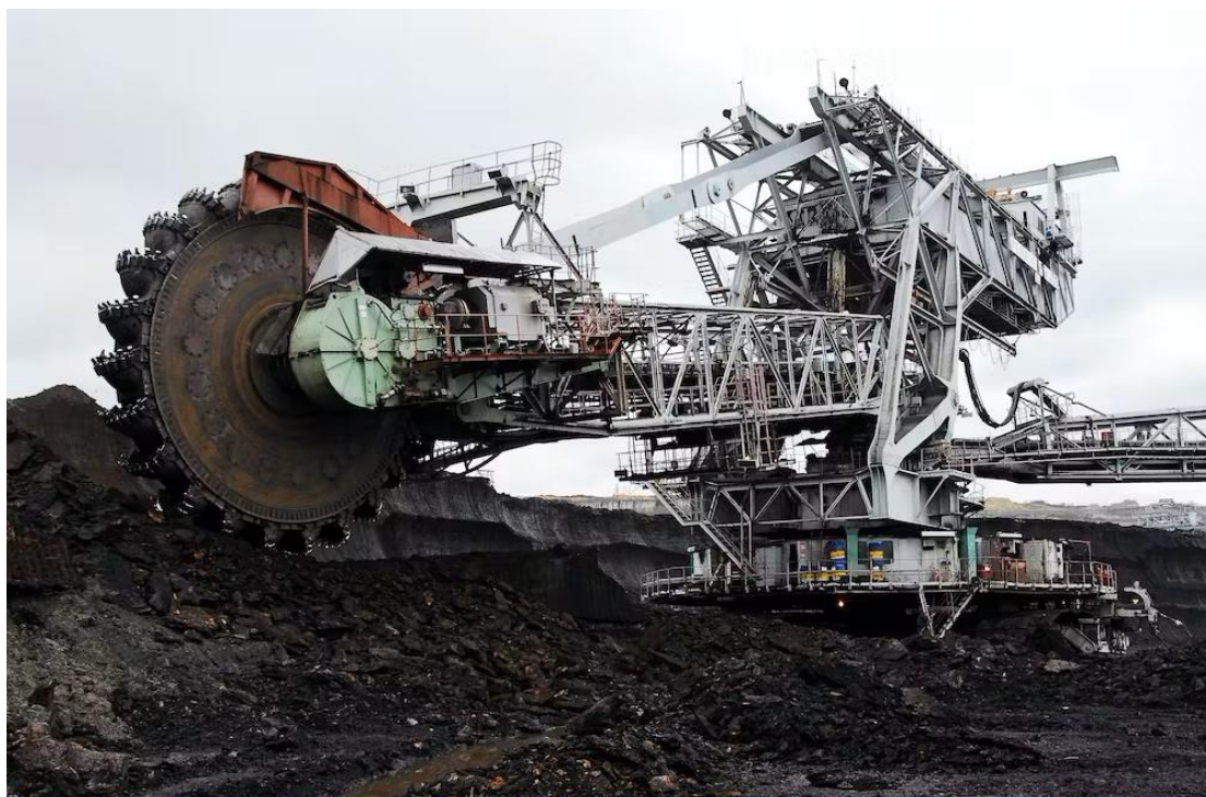
Εικόνα 8 Bucket Wheel Excavator στον οποίο είναι εμφανής ο μεγάλος τροχός με τους κάδους που διαθέτει
