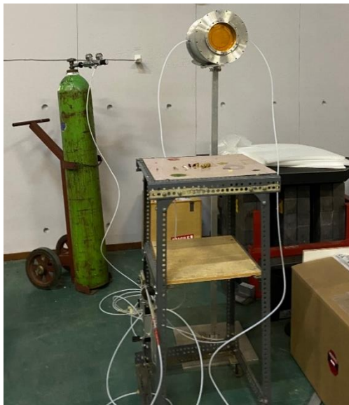
Σχήμα 2.3 : Άποψη της σύνδεσης του πειραματικού θαλάμου με τη μπουκάλια αερίου
