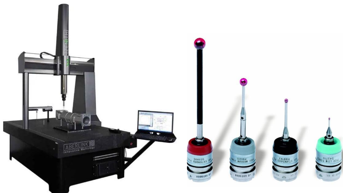
Εικόνα 2.1 : Σταθερή CMM Zenith 3 CNC της εταιρείας Aberlink (αριστερά) ( https://fts.gr ) & probes της εταιρείας Renishaw (δεξιά) ( https://willrich.com )
