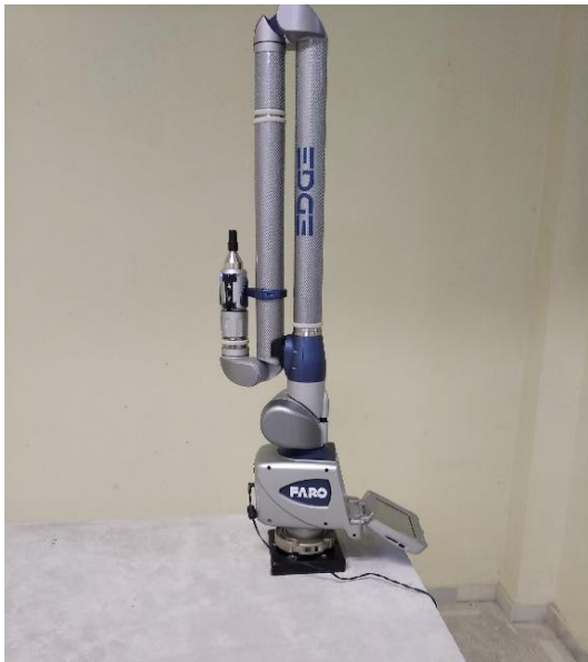
Εικόνα 4.1: Το Edge τοποθετημένο στη βάση του πάνω στο βάθρο (αριστερά) και η βιδωμένη βάση επί του βάθρου (δεξιά) (προσωπικό αρχείο)
