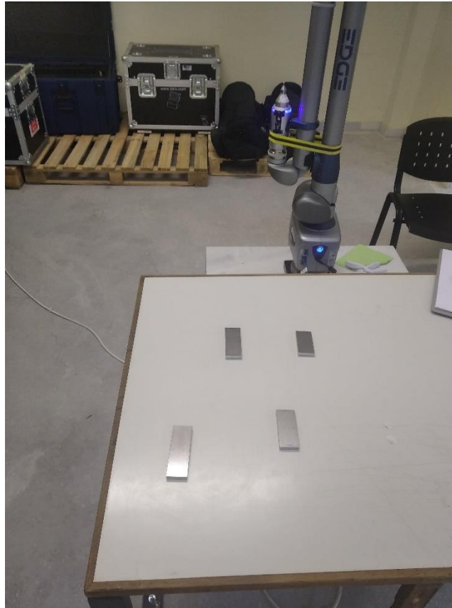
Εικόνα 4.6: Το βάθρο στο οποίο τοποθετούνταν ο βραχίονας και το τραπέζι όπου τοποθετούνταν τα δοκίμια στα τρία πρώτα σετ μετρήσεων (προσωπικό αρχείο)
