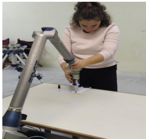
Εικόνα 3.2: Μετακίνηση των αρθρώσεων του βραχίονα κατά το Base Deflection (αριστερά & δεξιά) (προσωπικό αρχείο)
