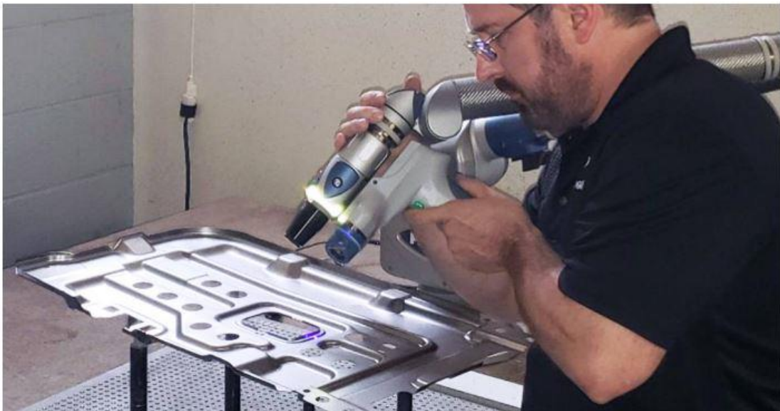
Εικόνα 1.2: Εφαρμογή βιομηχανικής γεωδαισίας στην αυτοκινητοβιομηχανία (www.faro.com)
