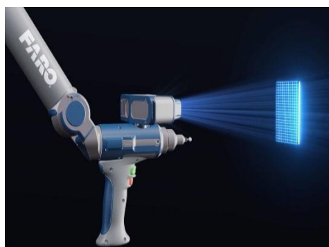
Εικόνα 2.5 : Φορητή μηχανή τύπου αρθρωτού βραχίονα (αριστερά) ( https://www.iglaser.co.za ) & Κεφαλή σάρωσης laser (δεξιά) ( https://www.faro.com )
