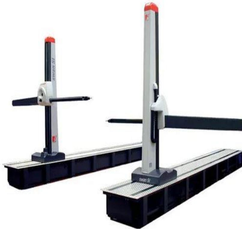
Εικόνα 2.3 : Τύπος οριζόντιου βραχίονα CMM (https://gaugehow.com)
