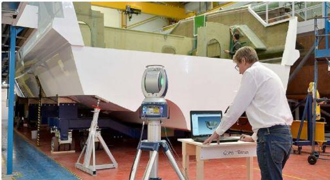
Εικόνα 1.1: Εφαρμογή βιομηχανικής γεωδαισίας για την κατασκευή σκάφους (www.faro.com)
