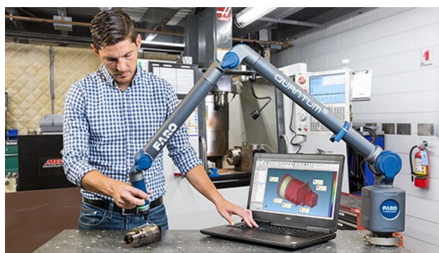
Εικόνα 2.5 : Φορητή μηχανή τύπου αρθρωτού βραχίονα (αριστερά) ( https://www.iglaser.co.za ) & Κεφαλή σάρωσης laser (δεξιά) ( https://www.faro.com )
