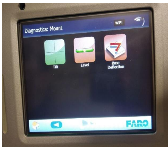
Εικόνα 3.3: Μενού επιλογής ελέγχων σταθερότητας (αριστερά) (προσωπικό αρχείο) και διευθύνσεις μετακίνησης των αρθρώσεων του βραχίονα κατά τον έλεγχο Tilt (δεξιά) ( https://www.faro.com )
