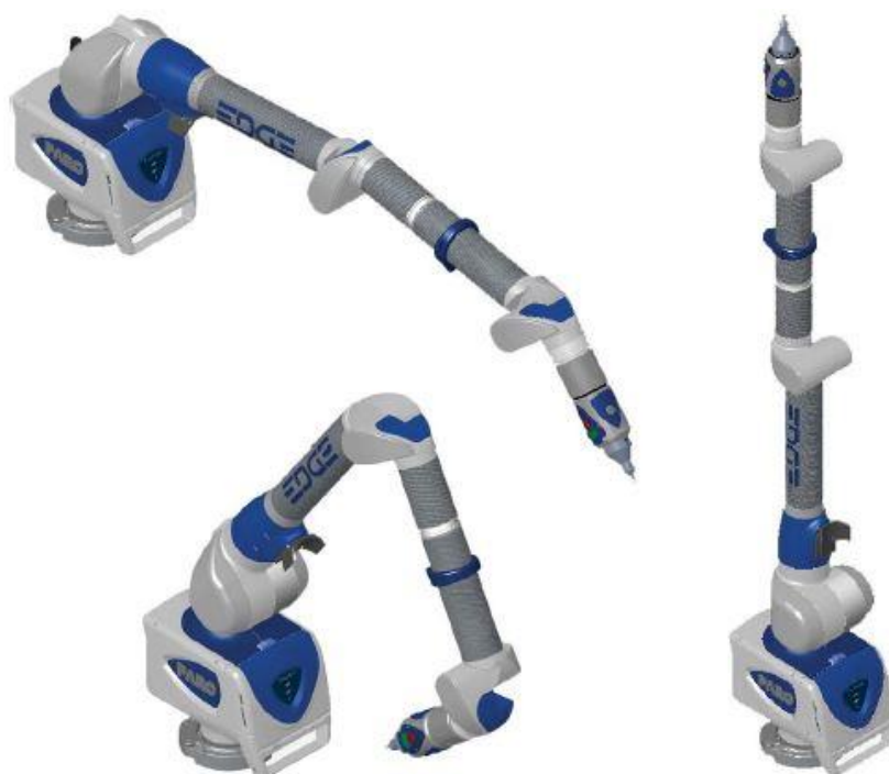
Εικόνα 3.6 : Περιπτώσεις μετακίνησης του βραχίονα που επιφέρουν απώλεια ενός βαθμού ελευθερίας («κλείδωμα» αρθρώσεων) ( https://www.faro.com )
