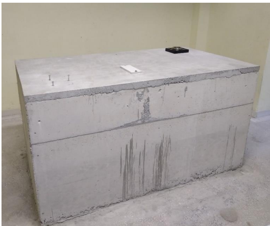
Εικόνα 4.3: Το κτισμένο βάθρο πάνω στο οποίο έχουν τοποθετηθεί η βάση (πάνω στην οποία σταθεροποιείται το Edge) και η λευκή επιφάνεια μέτρησης (προσωπικό αρχείο)
