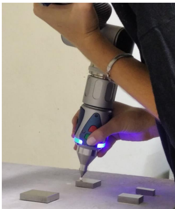
Εικόνα 4.5: Μέτρηση σημείων στην πρώτη επιφάνειας του δοκιμίου των 30mm με σφαιρικό αισθητήρα διαμέτρου 3mm (προσωπικό αρχείο)
