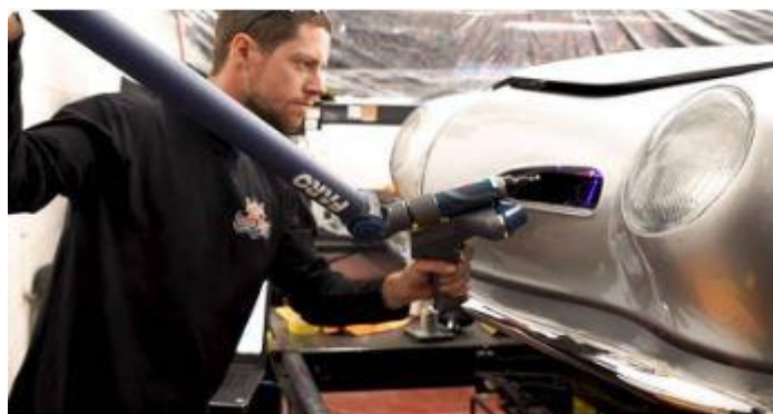
Εικόνα 2.10 : Χρήση CMM αρθρωτού βραχίονα στην αεροναυπηγική βιομηχανία (πάνω) και στην αυτοκινητοβιομηχανία (κάτω)( https://www.faro.com )
