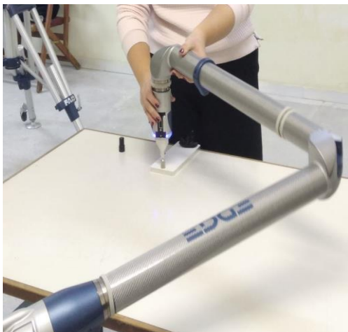
Εικόνα 3.2: Μετακίνηση των αρθρώσεων του βραχίονα κατά το Base Deflection (αριστερά & δεξιά) (προσωπικό αρχείο)
