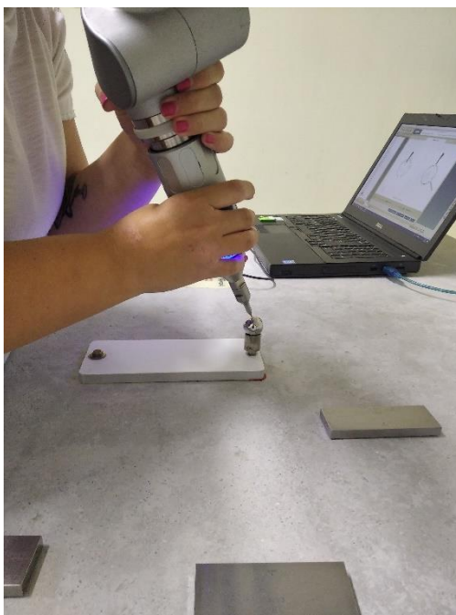
Εικόνα 4.4: Η ειδική σφαίρα διακρίβωσης πάνω στη λευκή επιφάνεια μέτρησης και ο συνδεδεμένος φορητός υπολογιστής (προσωπικό αρχείο)
