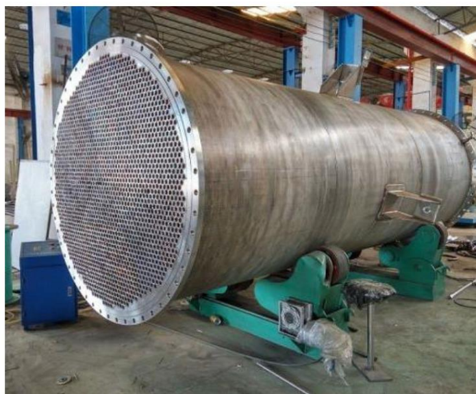
Σχήμα 2.2: Βιομηχανικός αυλωτός αντιδραστήρας.
