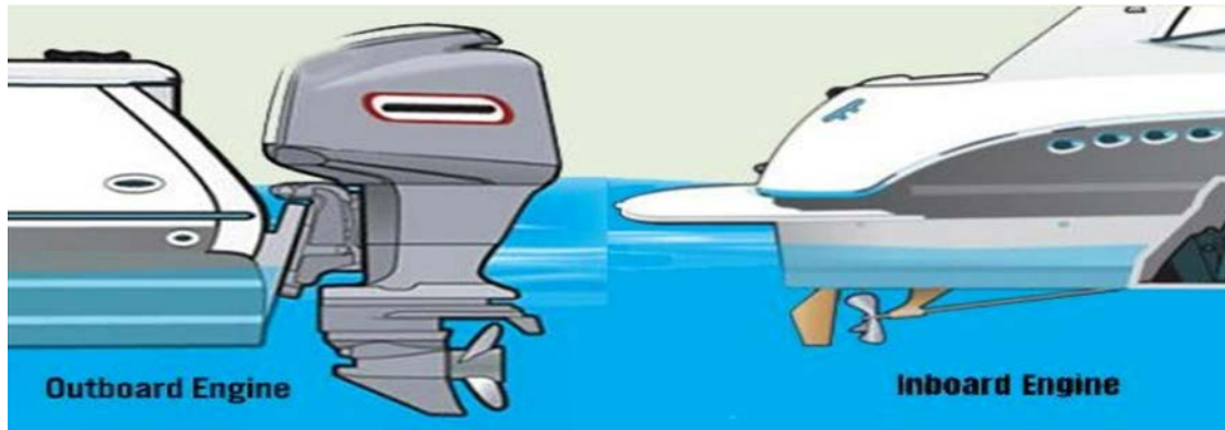
Σχήμα 4.2 Εξωλέμβια και Εσωλέμβια μηχανή.
