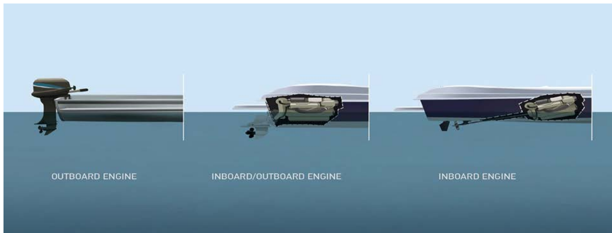
Σχήμα 4.3 Εξωλέμβια Εσω-εξωλέμβια και Εσωλέμβια μηχανή.
