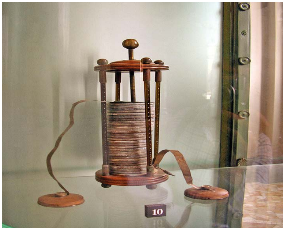
Σχήμα 4.4 Μια βολταϊκή στήλη στο Τέμπιο Βολτιάνο (ναός του Βόλτα), κοντά στο σπίτι του Volta στο Κόμο της Ιταλίας.
