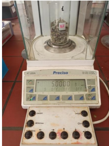
Εικόνα 4.1 - Αναλυτικός ζυγός 4 δεκαδικών ψηφίων.
