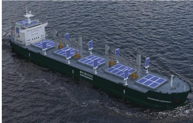
Εικόνα 3.18: Χρήση Φωτοβολταϊκών Πάνελ στην Ναυτιλία
