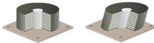
Εικόνα 4.2 Ελαστομεταλλικό εφέδρανο με πυρήνα μολύβδου.
