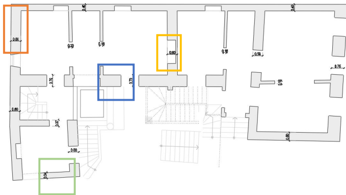
Εικόνα 3.5: Κάτοψη οροφής ισογείου και ένδειξη διαγώνιων ρωγμών
