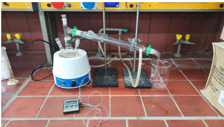
Σχήμα 8-6. Διάταξη πλάγιας απόσταξης για παραγωγή γαλακτικού αιθυλεστέρα.
