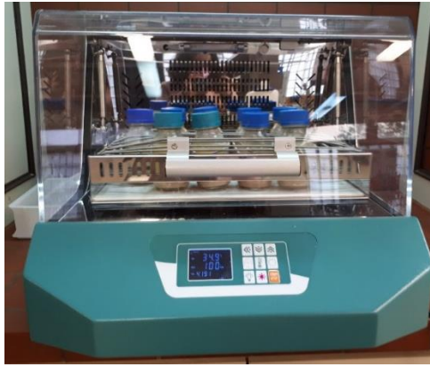
Σχήμα 7-5. Ανακινούμενο αερόλουτρο IKA KS 30001 control.
