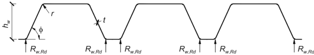
Figure 15.16: Διατομή τραπεζοειδούς χαλυβδόφυλλου, δηλ. διατομή με δύο ή περισσότερους μη ενισχυμένους κορμούς (από [32] και Σχήμα 6.8 του EN 1993-1-3:2006)
