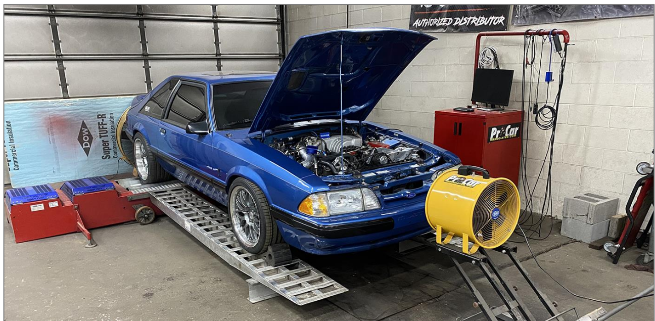
Σχήμα 4.1: Επιβατικό αυτοκίνητο τοποθετημένο σε δυναμόμετρο πλαισίου
