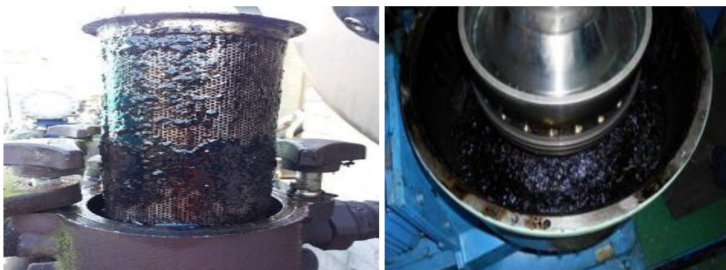
Εικόνα 7. Σχηματισμός υλός και απόφραξη φίλτρων, λόγω της ασυμβατότητας καυσίμων.
