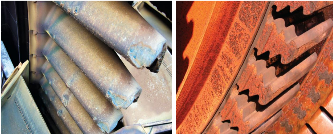
Εικόνα 5. Διάβρωση στον εξοπλισμό στροβίλου, λόγω της χρήσης καυσίμου με μεγάλη περιεκτικότητα σε νάτριο και βανάδιο.
