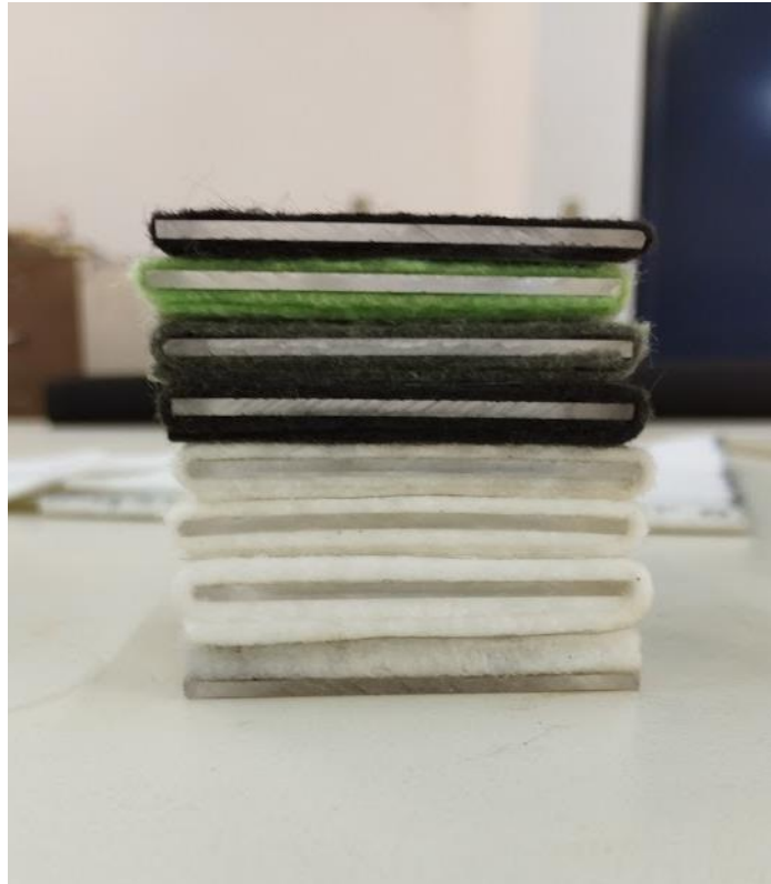
Εικόνα 36 Όλα τα γεωφάσματα που χρησιμοποιήθηκαν διαμορφωμένα και έτοιμα για δοκιμή (Προσωπική λήψη)
