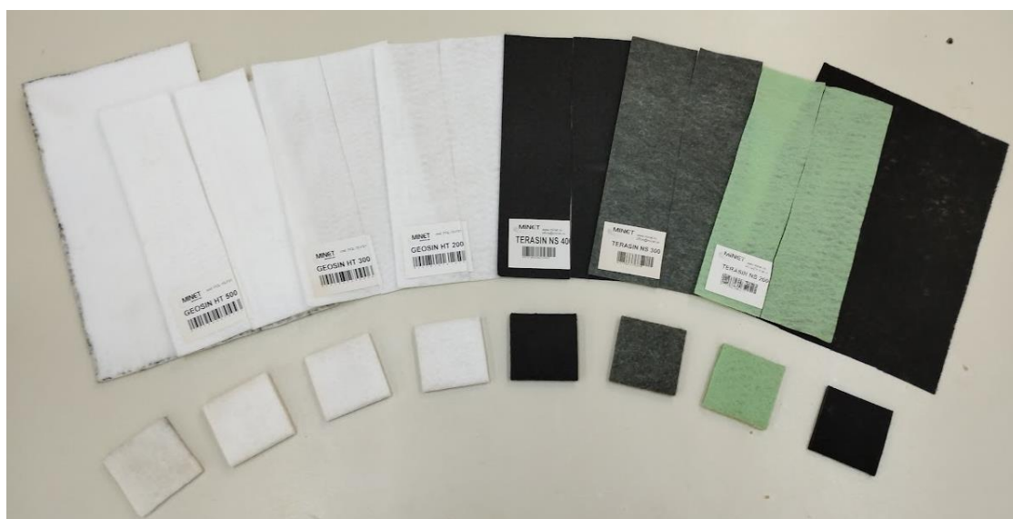
Εικόνα 27 Δείγματα γεωυφασμάτων που χρησιμοποιήθηκαν στις δοκιμές (Προσωπική λήψη)
