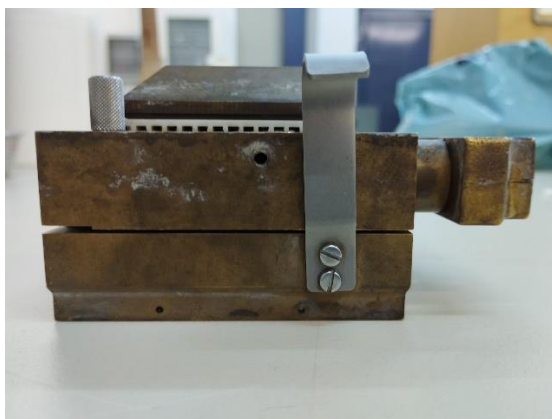
Εικόνα 8 Πραγματική και σχηματική διάταξη του υποδοχέα της συσκευής άμεσης διάτμησης (Προσωπική λήψη – Τεχνική Γεωλογία)
