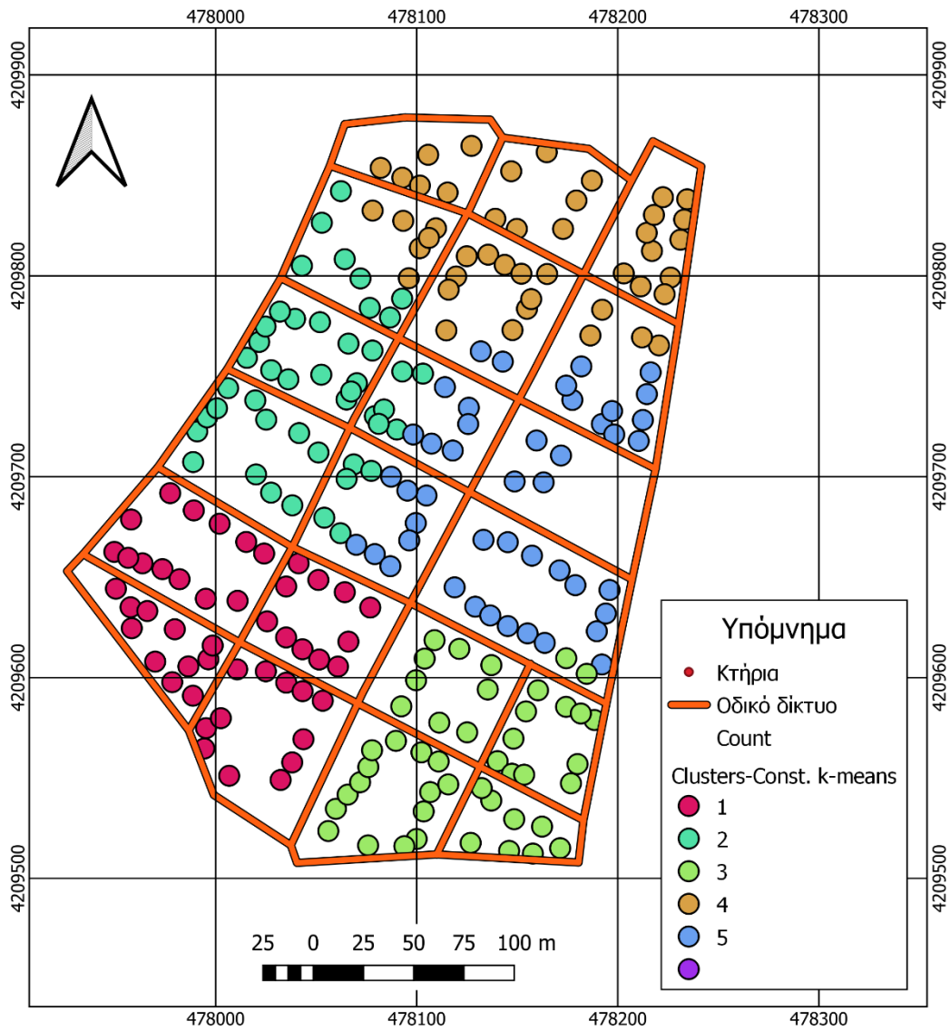
Εικόνα 20: Ομαδοποίηση σημείων με την μέθοδο k-means για \kappa=5 και Cluster size = 45.
