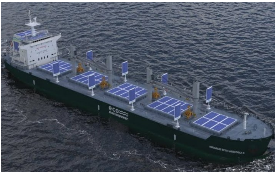
Εικόνα 51: Εγκατάσταση ηλιακών συλλεκτών στο κατάστρωμα ενός πλοίου
