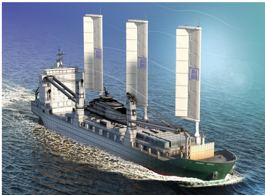
Εικόνα 50: Εγκατάσταση αιολικών συστημάτων βοηθητικής πρόωσης στα πλοία
