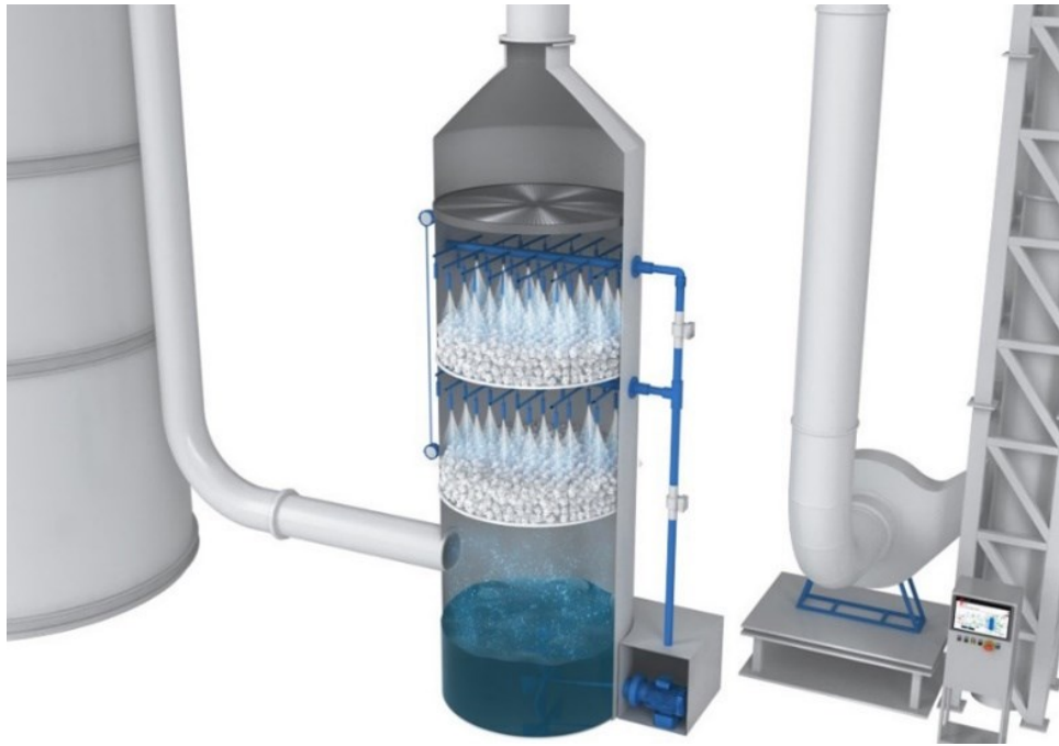
Εικόνα 27: Απεικόνιση του εσωτερικού χώρου ενός wet scrubber
