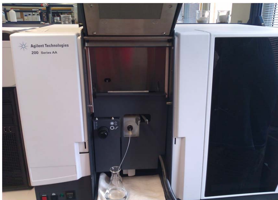
Μηχάνημα Ατομικής Απορρόφησης, για τον προσδιορισμό της συγκέντρωσης των μετάλλων
