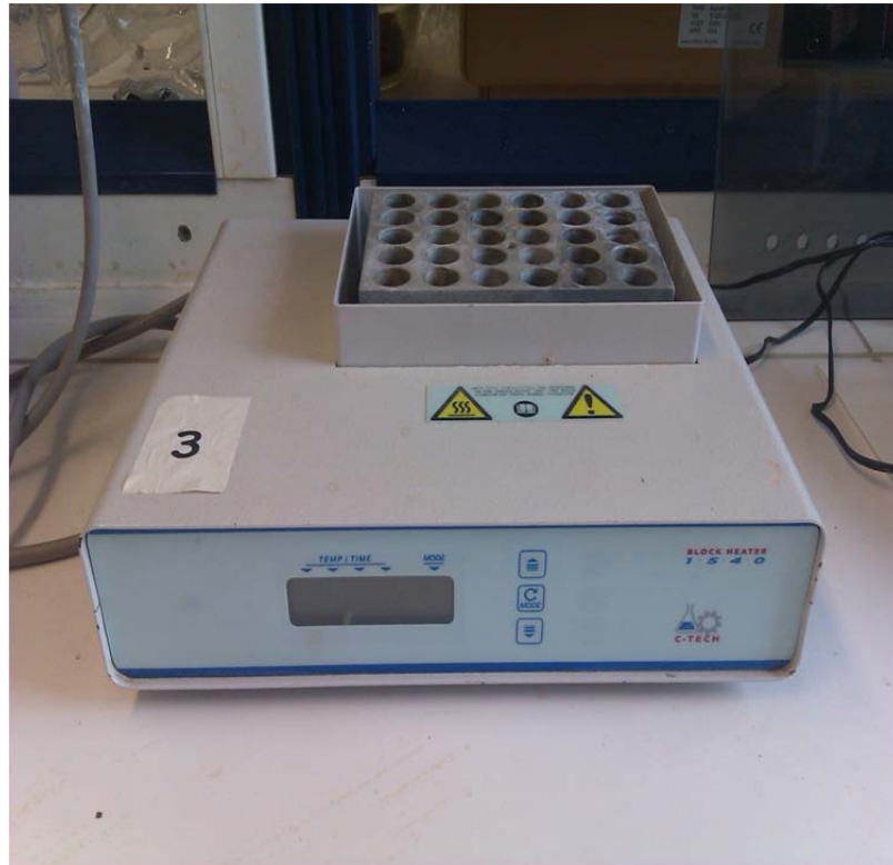
Θερμο-αντιδραστήρας, κατάλληλος για την χώνευση δειγμάτων σε δοκιμαστικούς σωλήνες
