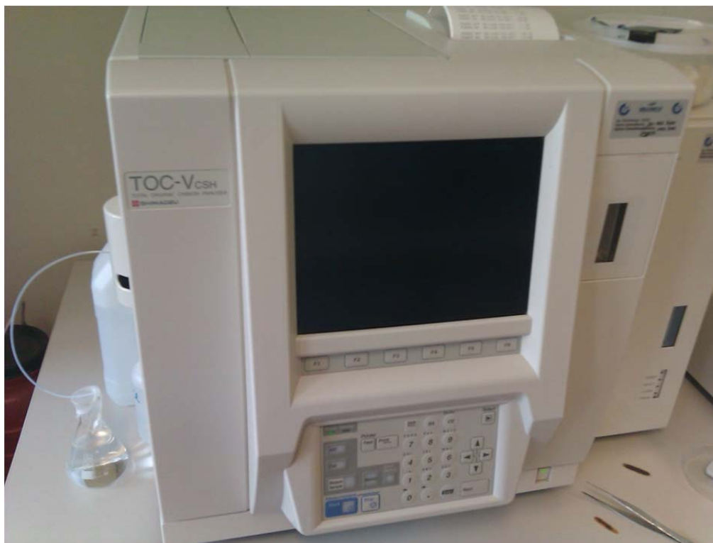
Μηχάνημα για την μέτρηση του ολικού οργανικού άνθρακα (T.O.C.)
