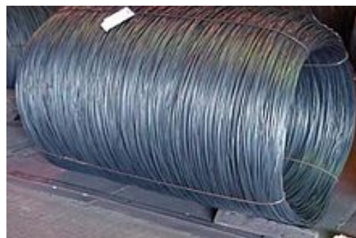
Εικόνα 1δ: Μπετόβεργα 8 χιλιοστών από χάλυβα σε ρολό
