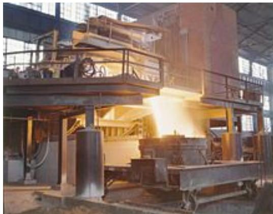
Εικόνα 1α: Απόχυση τηγμένου χάλυβα από κάμινο ηλεκτρικού τόξου σε αμερικανικό χαλουργείο (περί το 1941)
