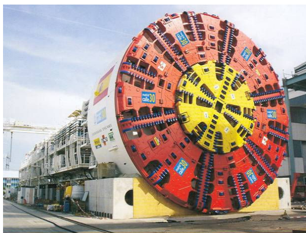
Σχήμα 3.2.10.1: Το μεγαλύτερο EPB TBM με διάμετρο 15,20m που χρησιμοποιήθηκε στη Μαδρίτη για τη κατασκευή οδικής σήραγγας Πηγή: Herrenknecht
