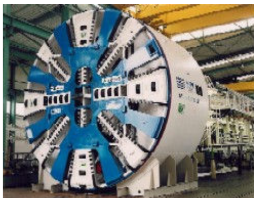
Σχήμα 3.2.18.3 : Ένα εκ των TBM που χρησιμοποιήθηκαν στο Μετρό των Αθηνών Πηγή: www.attikometro.gr
