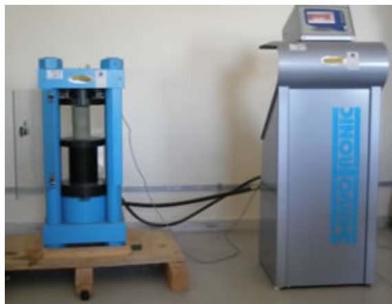
Σχήμα 3.5.9.2 : Συσκευή ανεμπόδιστης, μονοαξονικής θλίψης Πηγή: http://www.civil.ntua.gr/labs/foundation-eng
