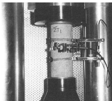
Σχήμα 3.5.17.1 : Δοκιμή μονοαξονικής, ανεμπόδιστης θλίψης (uniaxial compression test) Πηγή: Νεώτερες απόψεις για τις παραμέτρους μηχανικής συμπεριφοράς των πετρωμάτων- Γεώργιος Τσιαμπάος Αναπληρωτής Καθηγητής ΕΜΠ, Αθήνα, Ιανουάριος 2009
