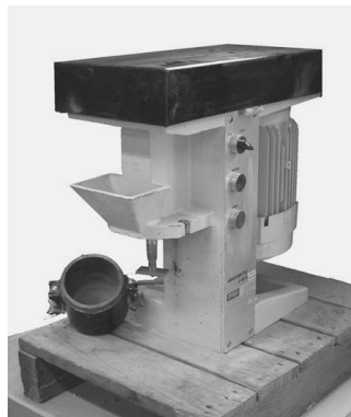
Σχήμα 3.5.13.3 : Συσκευή δοκιμής σκληρότητας LCPC Πηγή: New test methodology for estimating the abrasiveness of soils for TBM tunneling-B.Nilsen, F.Dahl, J.Holzhäuser, P.Raleigh
