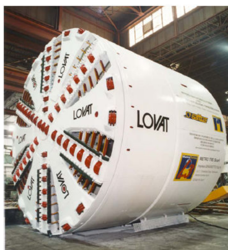
Σχήμα 3.2.18.7 : Ένα από τα TBM της εταιρείας Lovat Inc που Χρησιμοποιήθηκαν στο Μετρό του Τορίνο Πηγή: TBM and Lining Essential Interfaces-Nguyen Duc Toan (Politenico di Torino)
