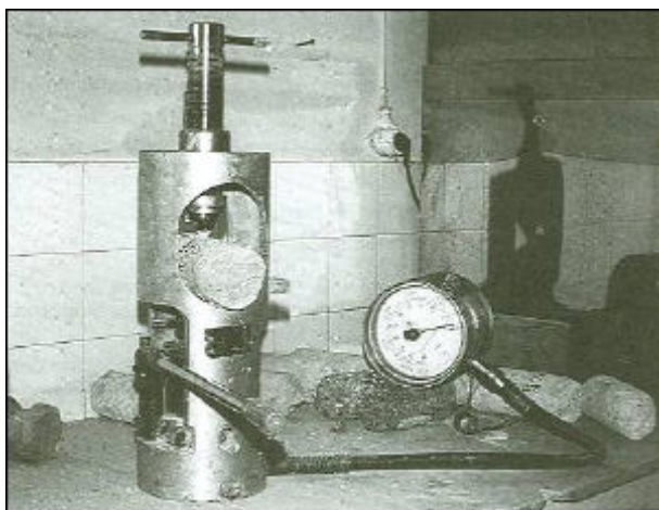
Σχήμα 3.5.17.2 : Συσκευή δοκιμής σημειακής φόρτισης (Point load test) Πηγή: Νεώτερες απόψεις για τις παραμέτρους μηχανικής συμπεριφοράς των πετρωμάτων- Γεώργιος Τσιαμπάος Αναπληρωτής Καθηγητής ΕΜΠ, Αθήνα, Ιανουάριος 2009
