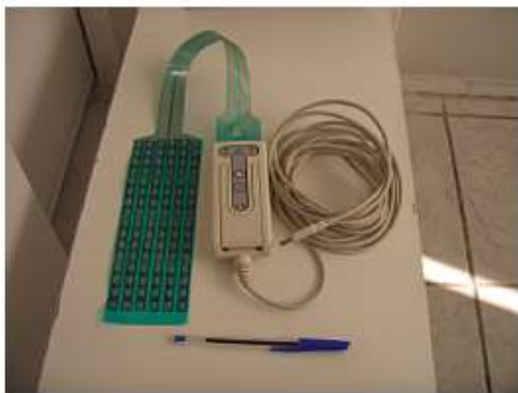
Εικόνα 2:20 Αισθητήρας καταμέτρησης αναπτυσσόμενων δυνάμεων (Evolution Sensor Handle) που χρησιμοποιήθηκε για τις ανάγκες της έρευνας. (πηγή : [107])
