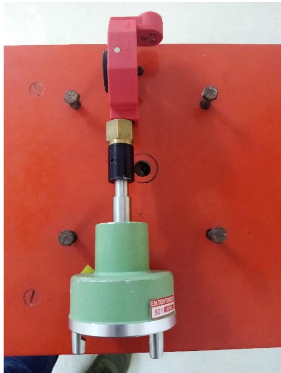
Εικόνα 3.5: Πρίσμα πάνω στην κατασκευασμένη βάση και τον ειδικό αντάπτορα που ανώνει την βάση αυτή με το τρικόχλιο.
