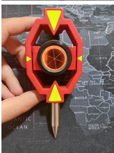
Εικόνα 2.9: Mini prism της εταιρίας Leica ιδανικό για χαράξεις με σταθερό και αμετάβλητο Ύψος Στόχου επίσης 10 εκατοστών το οποίο δίνεται από τον κατασκευαστή.
