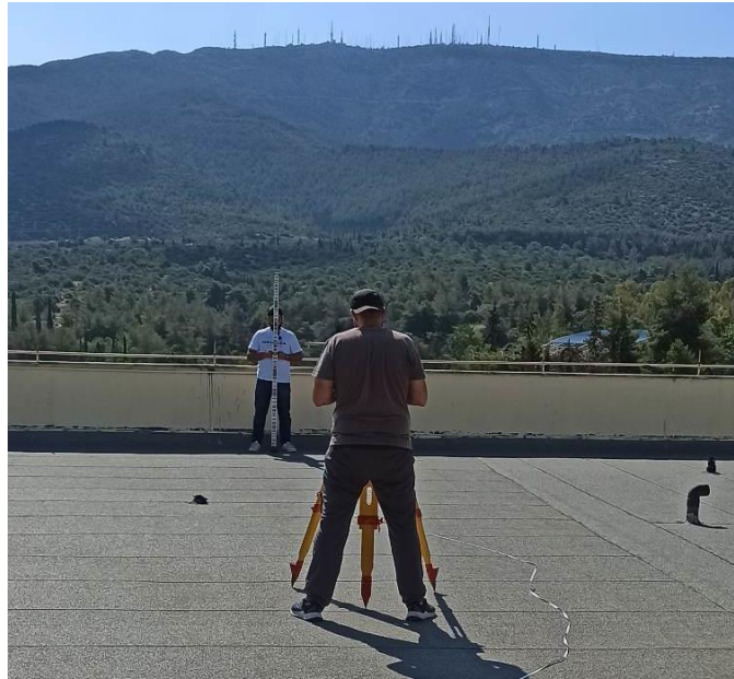
Εικόνα 4.3: Σταδία πάνω σε χελώνα σε τυχαίο σημείο B στο πεδίο και ο χωροβάτης λαμβάνει ανάγνωση.
