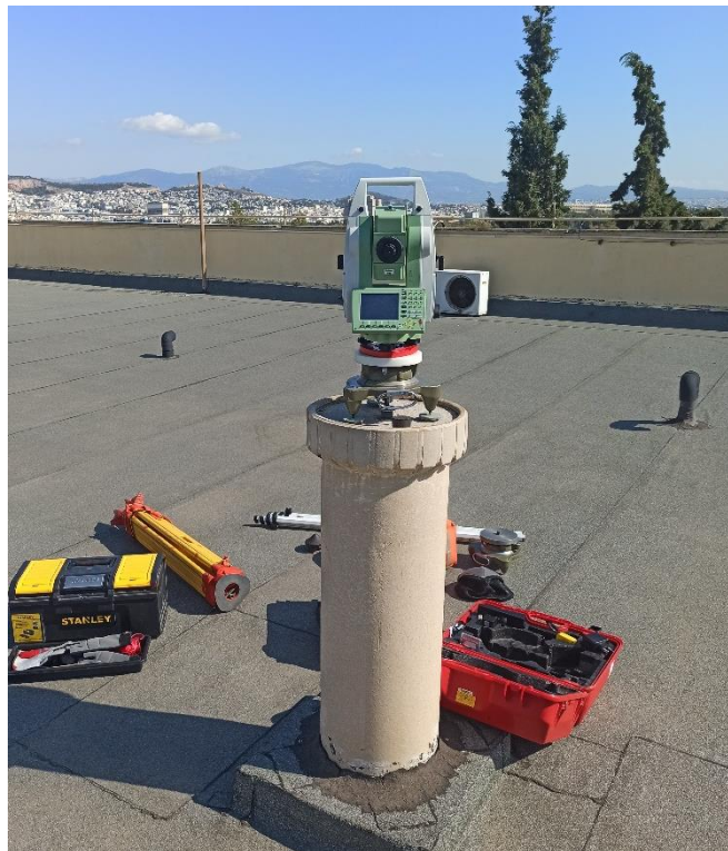
Εικόνα 4.1: Γεωδαιτικός σταθμός LEICA TCRM 1201 τοποθετημένος πάνω στο βάθρο T1 συντεταγμένων ( x = 100 , y = 100 ).
