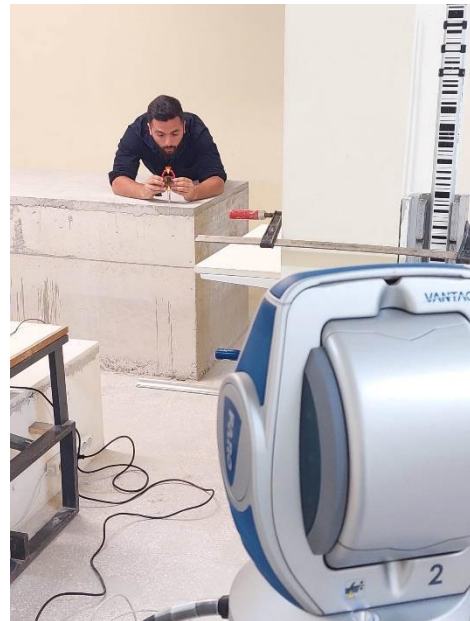
Εικόνα 3.13: Μέτρηση σημείου στο κέντρο του πρίσματος με την χρήση laser tracker.
