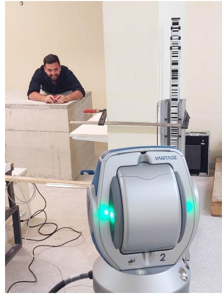
Εικόνα 3.12: Μέτρηση σημείων σε επίπεδη επιφάνεια με την χρήση laser tracker για τον υπολογισμό της εξίσωσης του επιπέδου.
