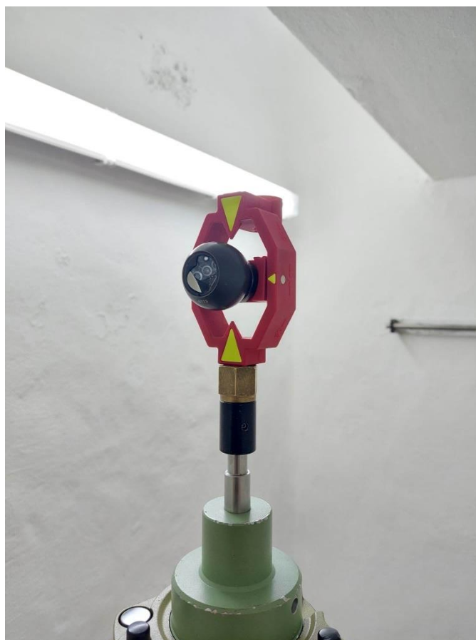
Εικόνα 3.8: Μετρήσεις 21 αποστάσεων με την χρήση του πρίσματος CCR 1.5'' που είναι τοποθετημένο στην βάση που κατασκευάστηκε.
