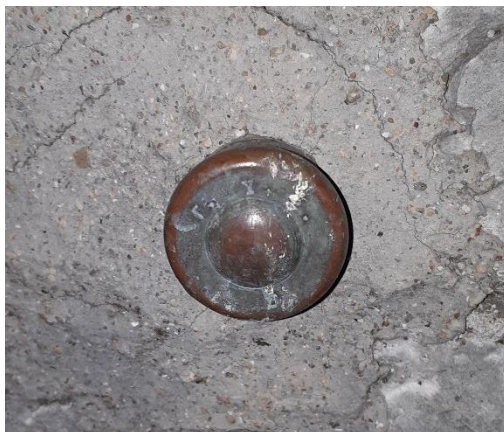
Εικόνα 1.4: Υψομετρική αφετηρία reper της ΓΥΣ.
