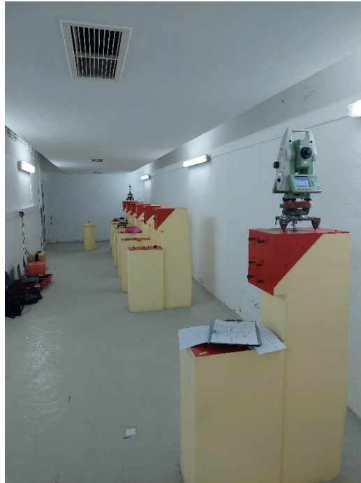
Εικόνα 3.10: Μέτρηση απόστασης από το Βάθρο B20 → B26 κατά την διεξαγωγή του 2 ου πειράματος.
