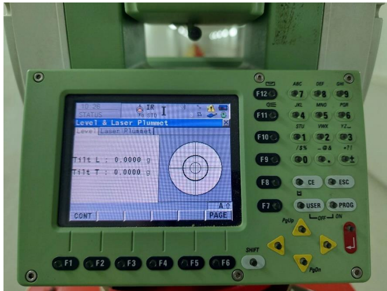
Εικόνα 3.6: Ψηφιακή φουσαλίδα κέντρωσης γεωδαιτικού σταθμού LEICA TCRM 1201
