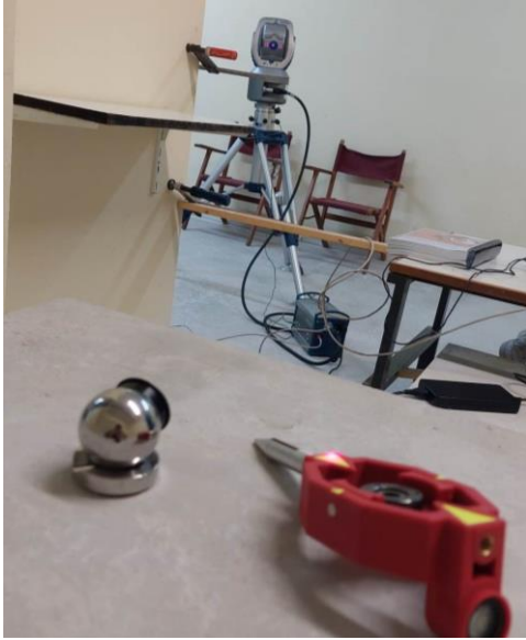
Εικόνα 3.12: Μέτρηση σημείων σε επίπεδη επιφάνεια με την χρήση laser tracker για τον υπολογισμό της εξίσωσης του επιπέδου.
