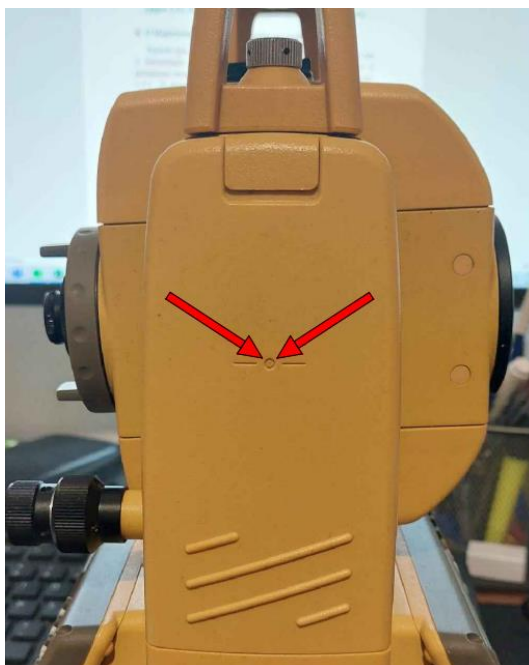
Εικόνα 2.4: Σημείο μέτρησης ύψους οργάνου γεωδαιτικού σταθμού Topcon GPT-3005LN
