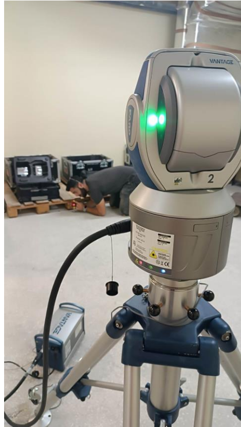
Εικόνα 4.24: Αποτύπωση σημείων του κύκλου , του κέντρου του κύκλου με την χρήση laser tracker.
