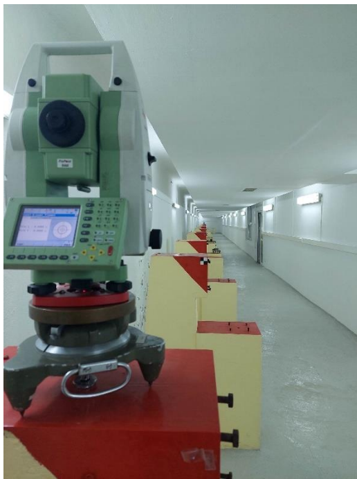
Εικόνα 3.7: Διαδικασία μετρήσεων στο τούνελ μετρολογικού ελέγχου της ΣΑΤΜΓ.
