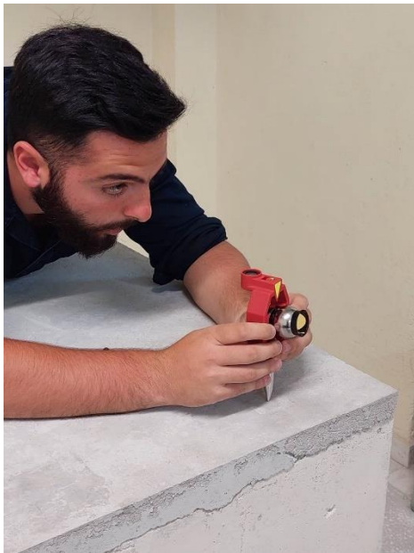
Εικόνα 3.13: Μέτρηση σημείου στο κέντρο του πρίσματος με την χρήση laser tracker.
