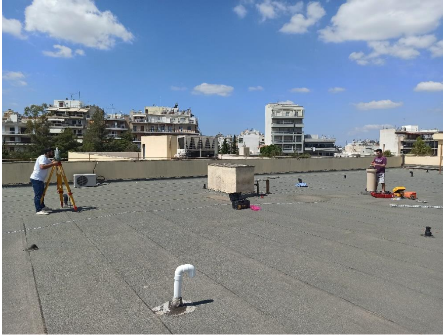
Εικόνα 4.14: Μέθοδος υψομετρικής χάραξης MLM γεωδαιτικός σταθμός σκοπεύει την υψομετρική αφετηρία.
