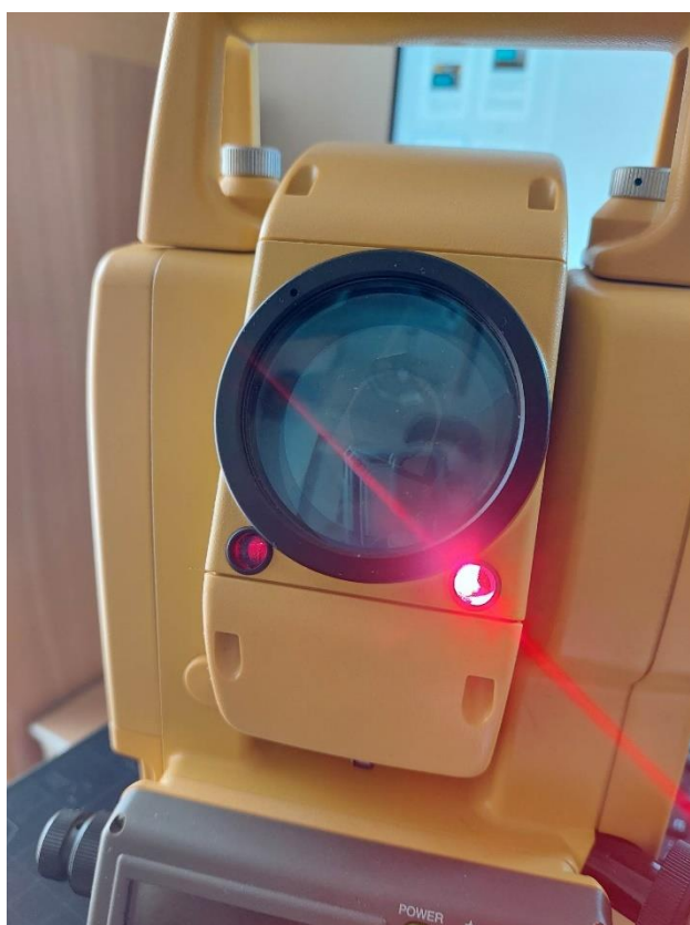
Εικόνα 1.8: Οδηγοί χάραξης γεωδαιτικού σταθμού Topcon GPT-3005LN
