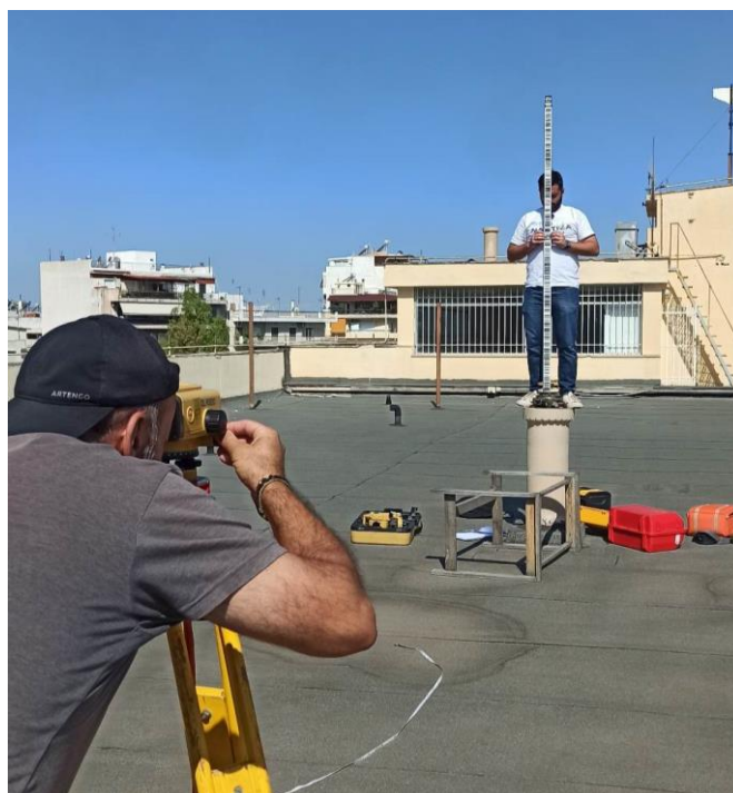
Εικόνα 4.2: Σταδία στην στέψη βάσης εξαναγκασμένης κέντρωσης έστω σε σημείο A και ο χωροβάτης λαμβάνει ανάγνωση.
