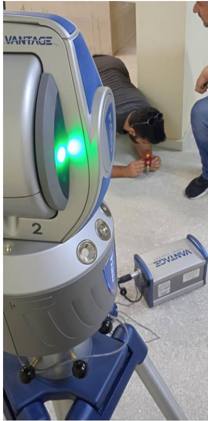
Εικόνα 4.24: Αποτύπωση σημείων του κύκλου , του κέντρου του κύκλου με την χρήση laser tracker.
