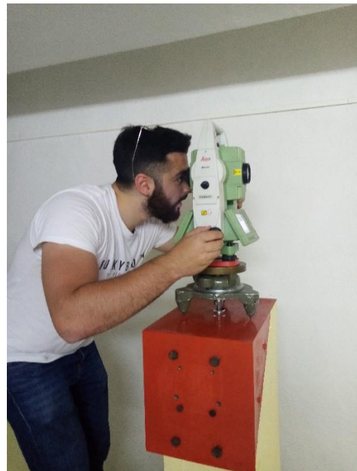
Εικόνα 3.7: Διαδικασία μετρήσεων στο τούνελ μετρολογικού ελέγχου της ΣΑΤΜΓ.
