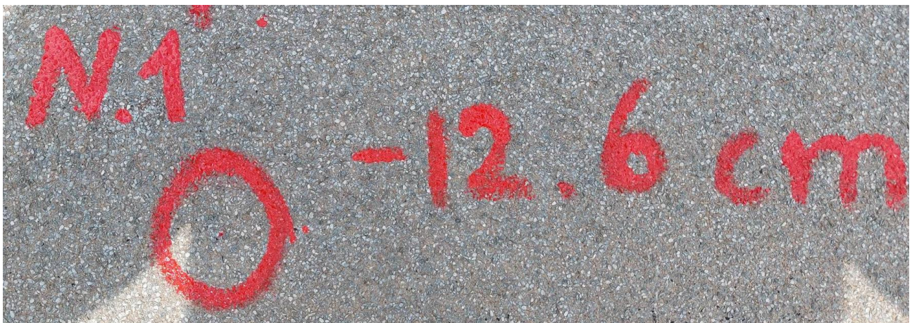
Εικόνα 4.7: Υλοποιημένο σημείο οριζοντιογραφικής και υψομετρικής χάραξης του σημείου 1 (τριδιάστατη) .
