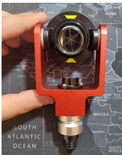
Εικόνα 2.8: Mini prism ιδανικό για χαράξεις με σταθερό και αμετάβλητο Ύψος Στόχου 10 εκατοστά το οποίο δίνεται από τον κατασκευαστή.
