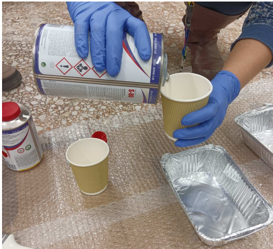
Σχήμα 16: Ανάμειξη των δύο συστατικών της ρητίνης.
