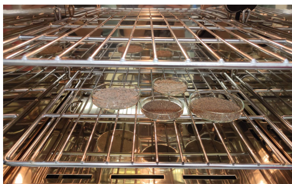
Σχήμα 10: Τοποθέτηση δειγμάτων στον φούρνο. Μπροστά και δεξιά φαίνονται τα δείγματα φωσφορίτη ενώ πίσω και αριστερά τα δείγματα φωσφογύψου.
