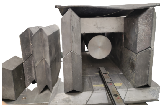
Σχήμα 19: Ο ανιχνευτής γερμανίου με την μολύβδινη θωράκιση.
