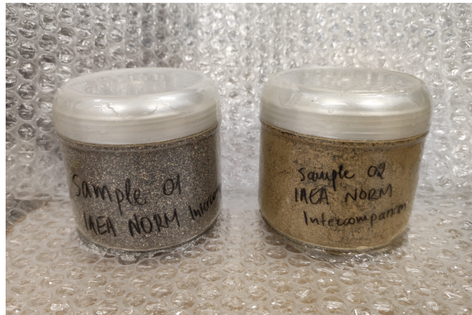
Σχήμα 18: Τα δύο δείγματα μετά την εφαρμογή ρητίνης για να σφραγιστούν. Αριστερά φαίνεται το δείγμα φωσφορίτη και δεξιά το δείγμα φωσφογύψου.
