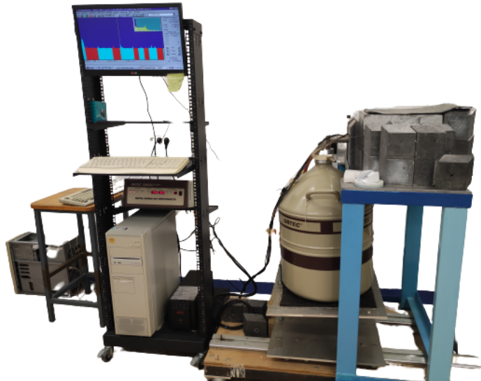
Σχήμα 20: Διάταξη φασματοσκοπίας γάμμα. Από αριστερά προς τα δεξιά: Ο ηλεκτρονικός υπολογιστής και το σύστημα ηλεκτρονικών, αμέσως μετά το δοχείο υγρού αζώτου και τέλος ο ανιχνευτής.
