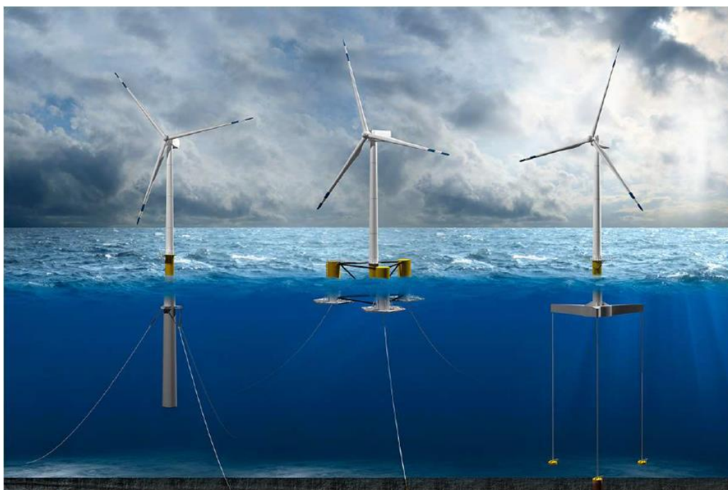
Εικόνα 5 - Τα τρία βασικά είδη πλωτών βάσεων (αριστερά προς δεξιά): Spar Buoyancy, Semi-submersible, Tension Leg Platform [7]
