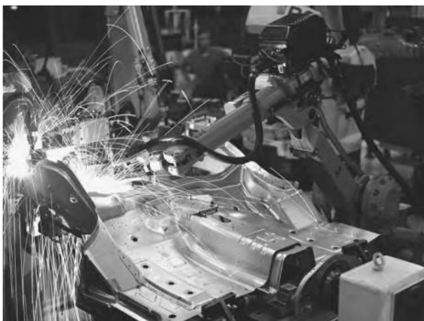
Εικόνα 1 : Συγκόλληση με λέιζερ αμαξώματος αυτοκινήτου [1]
