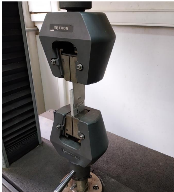
Εικόνα 27 : Συγκολλημένα ελάσματα στη μηχανή εφελκυσμού
