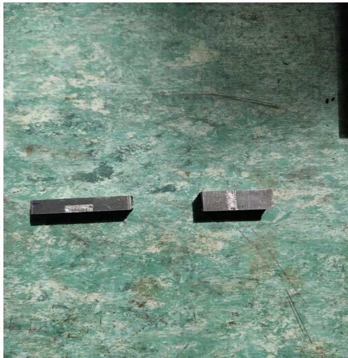
Εικόνα 15 : Σημείο συγκόλλησης κομμένων δοκιμίων
