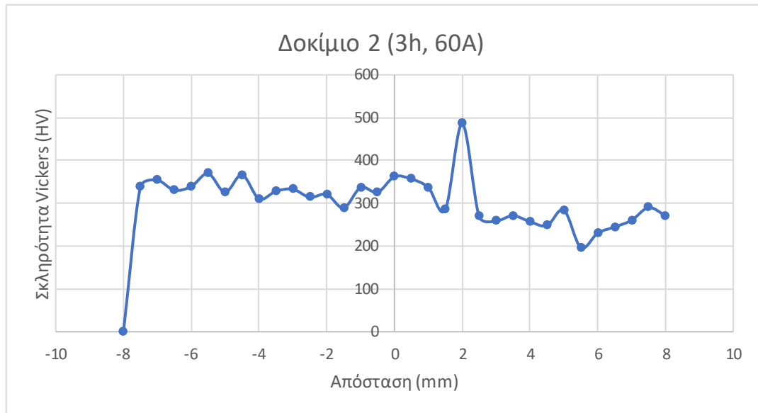
Εικόνα 3.43: Διάγραμμα κατανομής μικροσκληρότητας Vickers κάθετα της τομής του μετάλλου συγκόλλησης του δοκιμίου 2.
