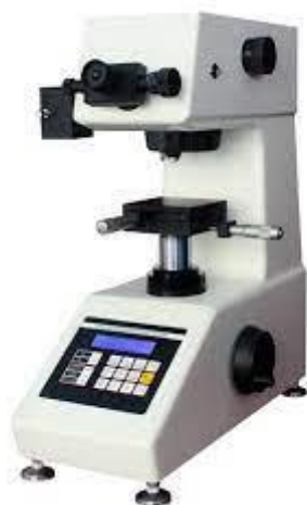
Εικόνα 2.7: Μικροσκληρόμετρο Vickers HV-1000Z που χρησιμοποιήθηκε για τη μελέτη μηχανικών ιδιοτήτων.
