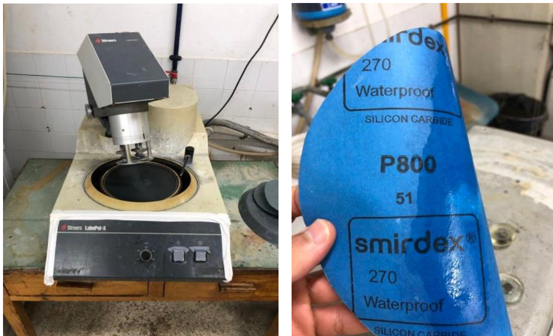
Εικόνα 2.2: Αριστερά : Λειαντικό μηχάνημα Struers LaboPol-5. Δεξιά: Λειαντικό χαρτί καρβιδίου του πυριτίου, 800 grid.
