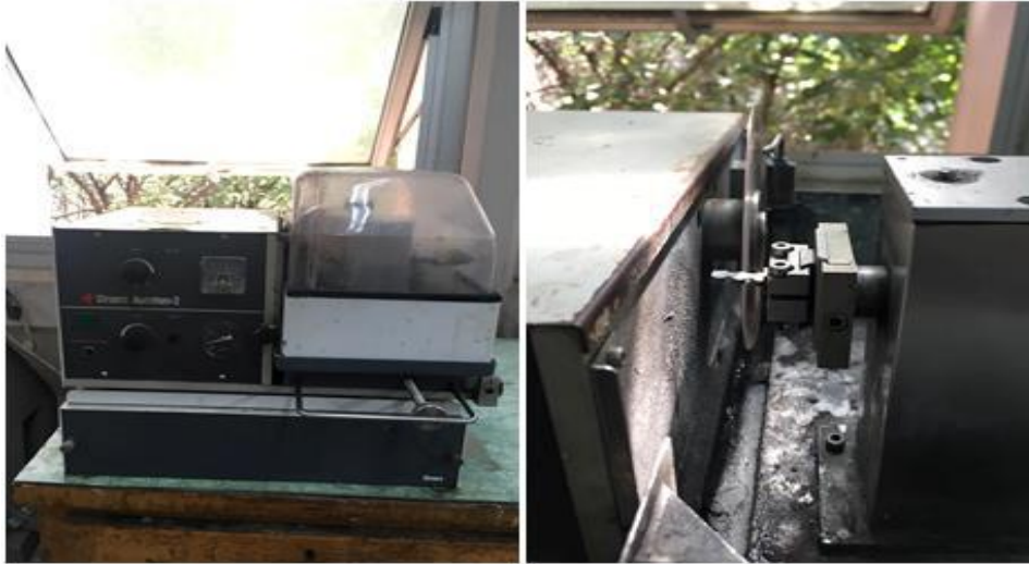
Εικόνα 22. Μικροτόμος Struers Accutom-2 και διαδικασία κοπής δειγμάτων
