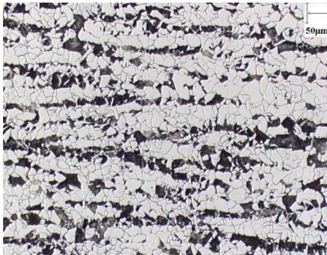
Εικόνα 25. Φερριτο-περλιτική μικροδομή μετά από χημική προσβολή με Nital [31]
