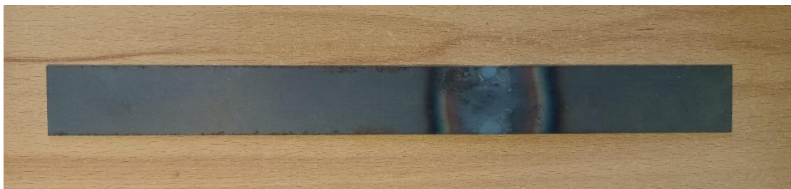
Σχήμα 46: Δοκίμιο φερρομαγνητικού χάλυβα με εμφανή φθορά
