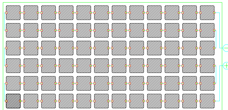
Σχ. 2-20. Κάτοψη Φ/Β πλαισίου 72 στοιχείων. [42]
