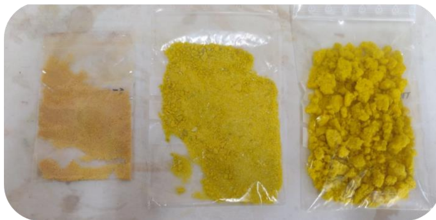
Εικόνα 7: Κρυσταλλικά ιζήματα θειοαντιμονιακού νατρίου όπως ανακτήθηκαν μετά την ψύξη των κυφορούντων διαλυμάτων της εκχύλισης αντιμονίου στους 13^\circ\text{C} , 10^\circ\text{C} και 8^\circ\text{C}
