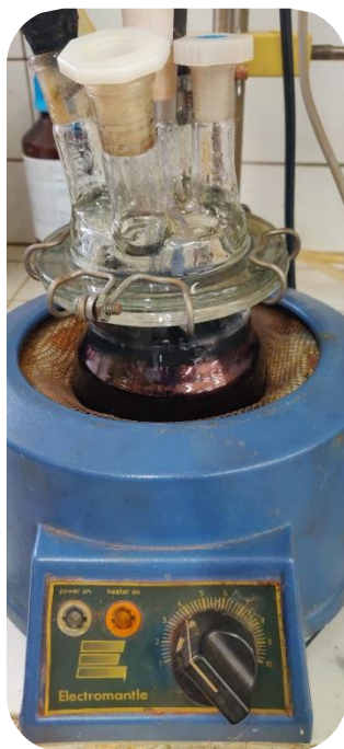
Εικόνα 5: Εικόνα από την εκχύλιση του συμπυκνώματος γαληνίτη Ολυμπιάδας
