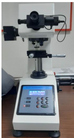
Εικόνα 3.21: Μικροσκληρόμετρο Εργαστηρίου Μεταλλογνωσίας της Σχολής Μεταλλειολόγων - Μεταλλουργών Μηχανικών
