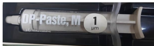
Εικόνα 3.10: Αδαμαντόπαστα μεγέθους 1 µm
