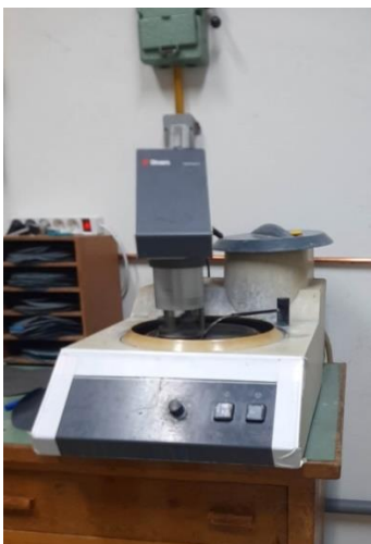
Εικόνα 3.7: Περιστροφικό τριβείο Εργαστηρίου Μεταλλογνωσίας της Σχολής Μεταλλειολόγων - Μεταλλουργών Μηχανικών
