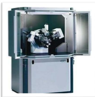
Εικόνα 3.16: Περιθλασίμετρο Ακτίνων X – XRD της Σχολής Μεταλλειολόγων - Μεταλλουργών Μηχανικών
