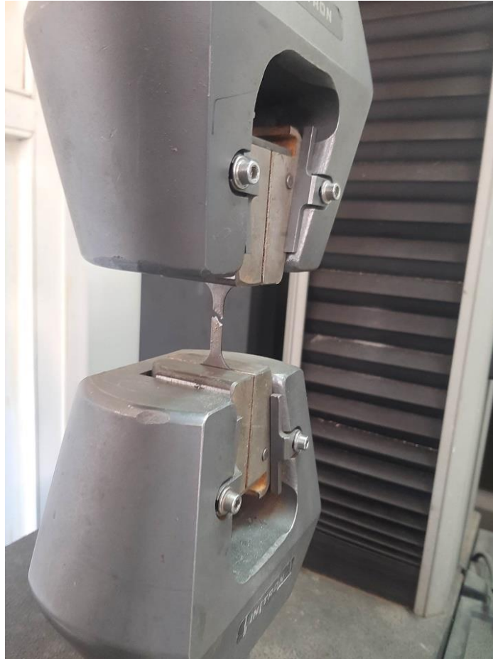
Εικόνα 3.24: Τελική θραύση δοκιμίου στη δοκιμή εφελκυσμού
