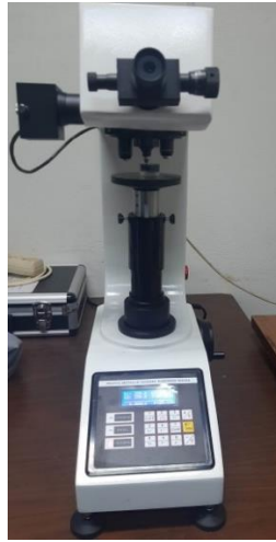
Εικόνα 3.20: Μάκροσκληρόμετρο Εργαστηρίου Μεταλλογνωσίας της Σχολής Μεταλλειολόγων - Μεταλλουργών Μηχανικών
