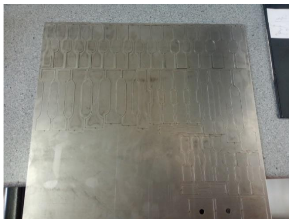
Εικόνα 3.1: Δοκίμια εφελκυσμού που αποκόπηκαν από φύλλο χάλυβα μέσω δέσμης laser
