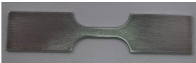
Εικόνα 3.2: Πρότυπο δοκίμιο (as received)
