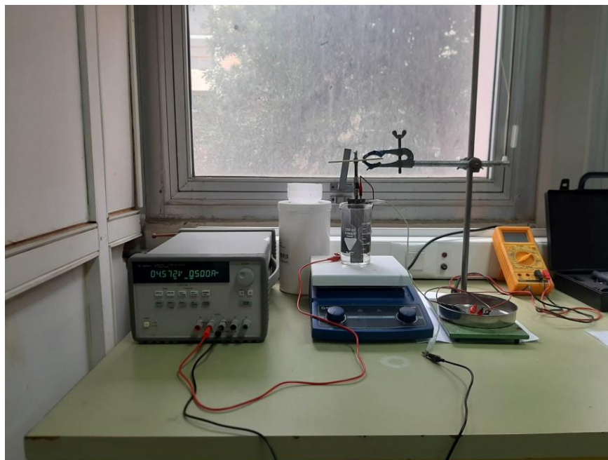
Εικόνα 3.3: Ηλεκτρολυτική διάταξη καθοδικής φόρτισης με υδρογόνο
