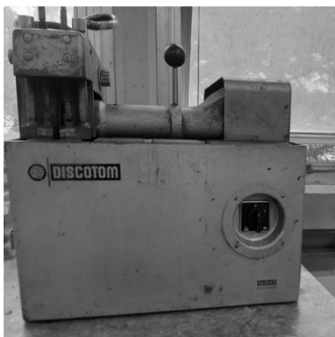
Εικόνα 3.4: Υδρόψυκτος πολύτροφος δισκοτόμος Εργαστηρίου Μεταλλογνωσίας της Σχολής Μεταλλειολόγων - Μεταλλουργών Μηχανικών
