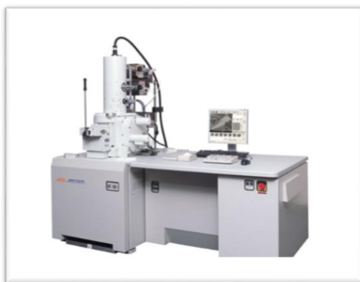
Εικόνα 3.13: Ηλεκτρονικό μικροσκόπιο Σάρωσης – SEM της Σχολής Μεταλλειολόγων - Μεταλλουργών Μηχανικών
