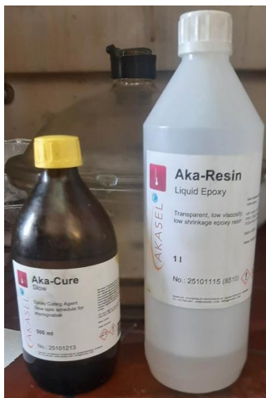
Εικόνα 3.5: Σκληρυντής και εποξική ρητίνη αντίστοιχα
