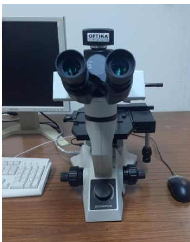
Εικόνα 3.12: Ανάστροφο οπτικό μικροσκόπιο Olympus Εργαστηρίου Μεταλλογνωσίας της Σχολής Μεταλλειολόγων - Μεταλλουργών Μηχανικών
