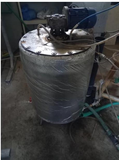
Εικόνα 2: Ο βιοαντιδραστήρας πιλοτικής κλίμακας που χρησιμοποιήθηκε για την αναερόβια συν-χώνευση του μίγματος FMSW condensate/WAS
