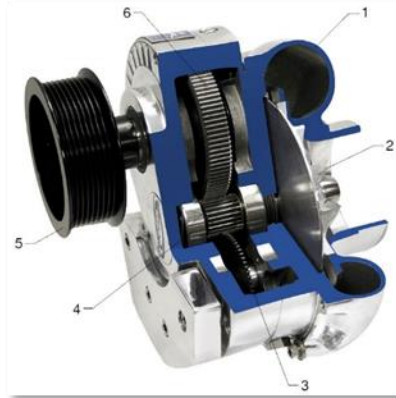
Σχήμα 1.7: Παράδειγμα μηχανικού υπερπληρωτή με μαντοκίνηση
