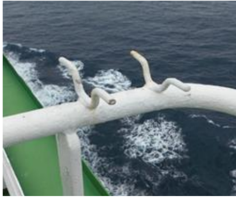
Εικόνα 34: Ειδική διαμόρφωση στερέωσης πυροσβεστικής μάνικας
