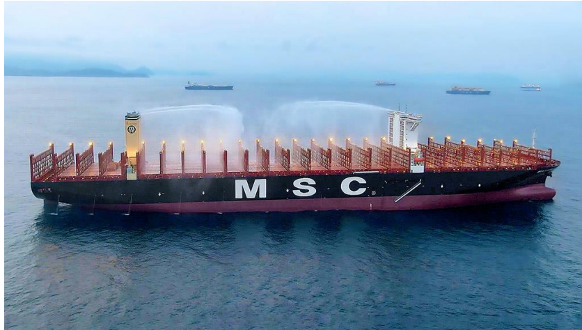
Εικόνα 28: Πυρόσβεση μέσω μονίμων εγκατεστημένων κανονιών 50
