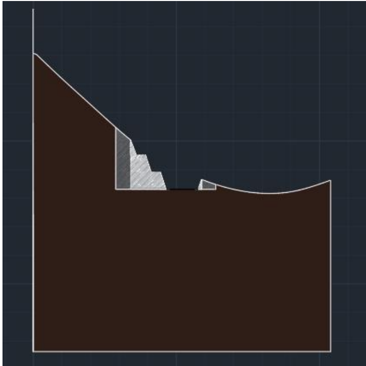
Εικόνα 109. Διαμόρφωση βαθμίδων στην θέση 1+494.5m, εναλλακτικός σχεδιασμός με βαθμίδες και στις δύο πλευρές
