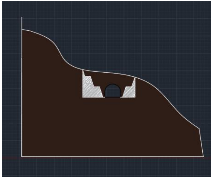
Εικόνα 98. Διαμόρφωση βαθμίδων στη θέση 0+0013m
