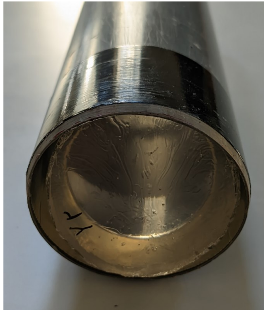
Εικ. 4.11 Τοποθέτηση πολυεποξικού ανιχνευτή στο αριστερό άνοιγμα του σωλήνα PVC
