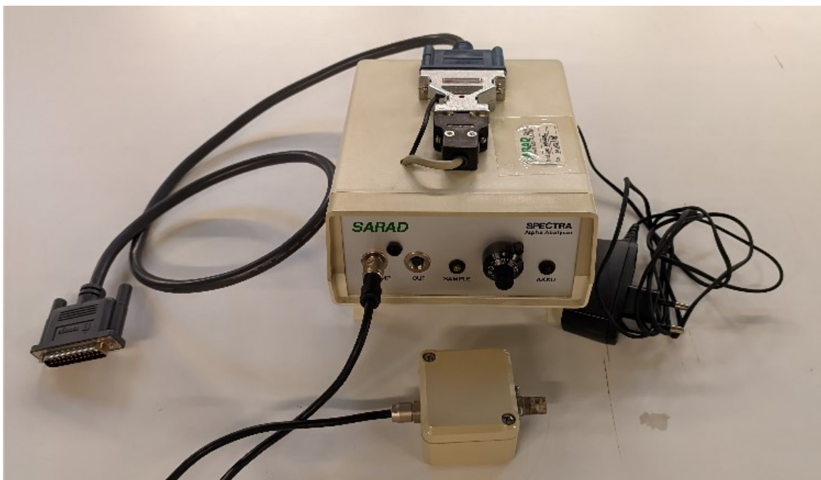
Εικ. 4.25 Πολυκαναλικός αναλυτής Alpha Analyzer εταιρείας κατασκευής SARAD.
