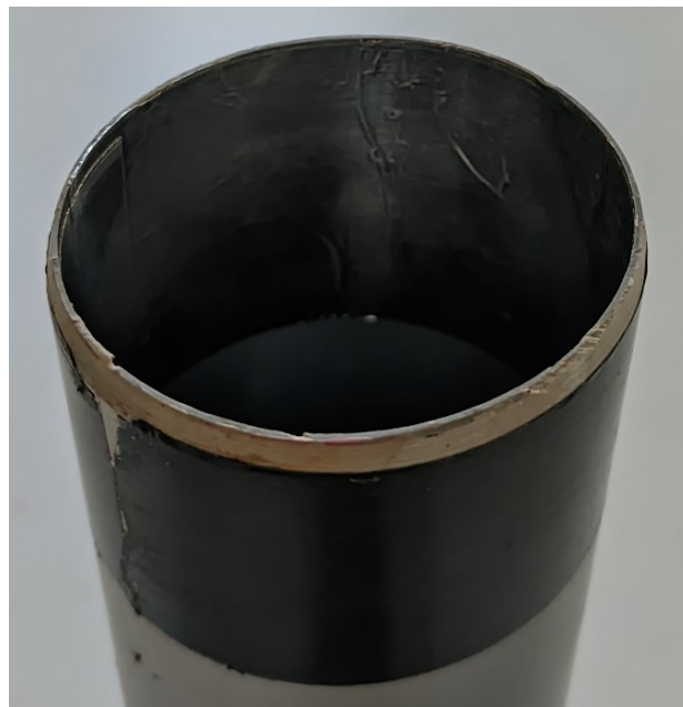
Εικ. 4.12 Ανακλαστική ταινία αλουμινίου γύρω από τον πολυεποξικό ανιχνευτή
