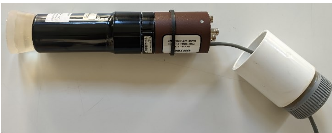
Εικ. 4.9 Από αριστερά: πολυεποξικός ανιχνευτής, φωτοπολλαπλασιαστής και διαιρέτης τάσης μαζί με προενισχυτή
