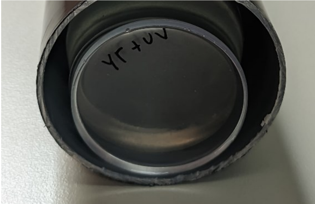
Εικ. 5.4 Τοποθέτηση πολυεποξικού ανιχνευτή μορφής δίσκου μικρού πάχους στο αριστερό άνοιγμα του σωλήνα PVC
