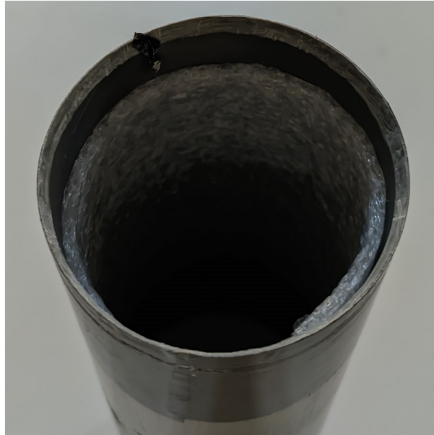
Εικ. 4.13 Κωνικότητα στο δεξί άνοιγμα του σωλήνα PVC
