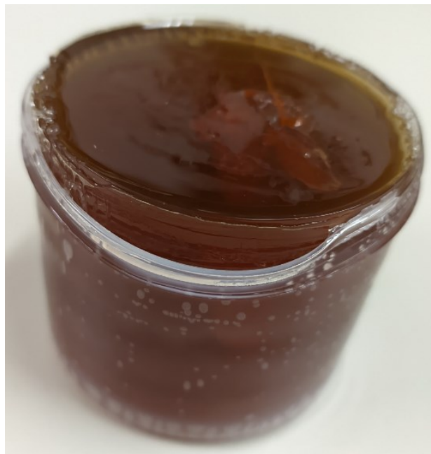
Εικ. 3.12 Τελικό αποτέλεσμα για χυτό από θιξοτροπικό πολυεστέρα
