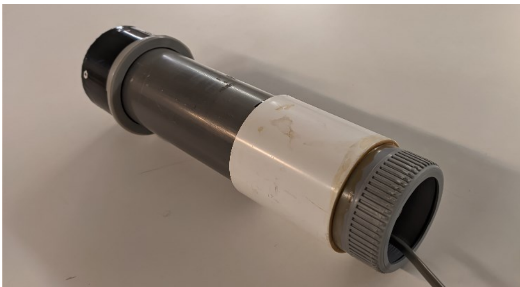
Εικ. 4.18 Το σύστημα φωτοπολλαπλασιαστή - διαιρέτη τάσης - προενισχυτή στην ασφαλή (φωτοστεγανή) του τελική θέση στο δεξί άνοιγμα του σωλήνα PVC. Τρίτη εικόνα κάτω: όλη η διάταξη στη φωτοστεγανή της θήκη.
