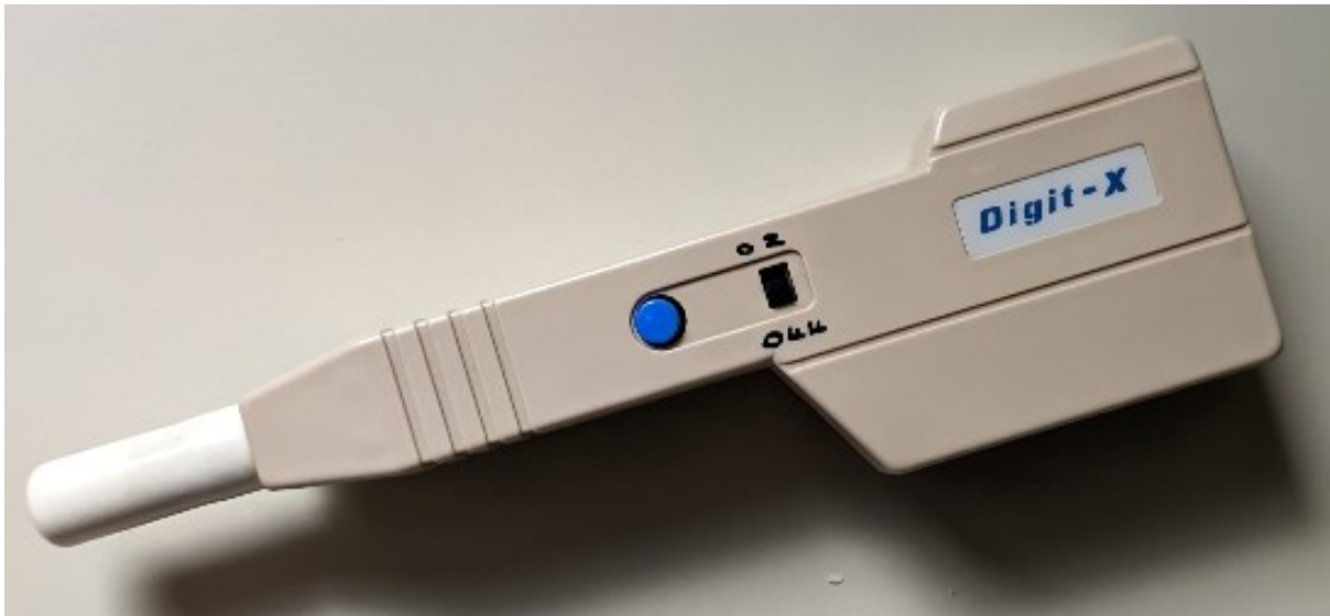
Εικ. 4.6 Μετρητής οπτικής πυκνότητας (τύπος Digit-X της εταιρείας FIDGEON)
