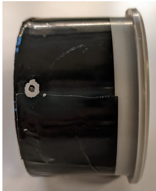
Εικ. 4.15 Οπή στη μούφα για την προστασία του φύλλου αλουμινίου από υπερπίεσεις - υποπίεσεις αέρα
