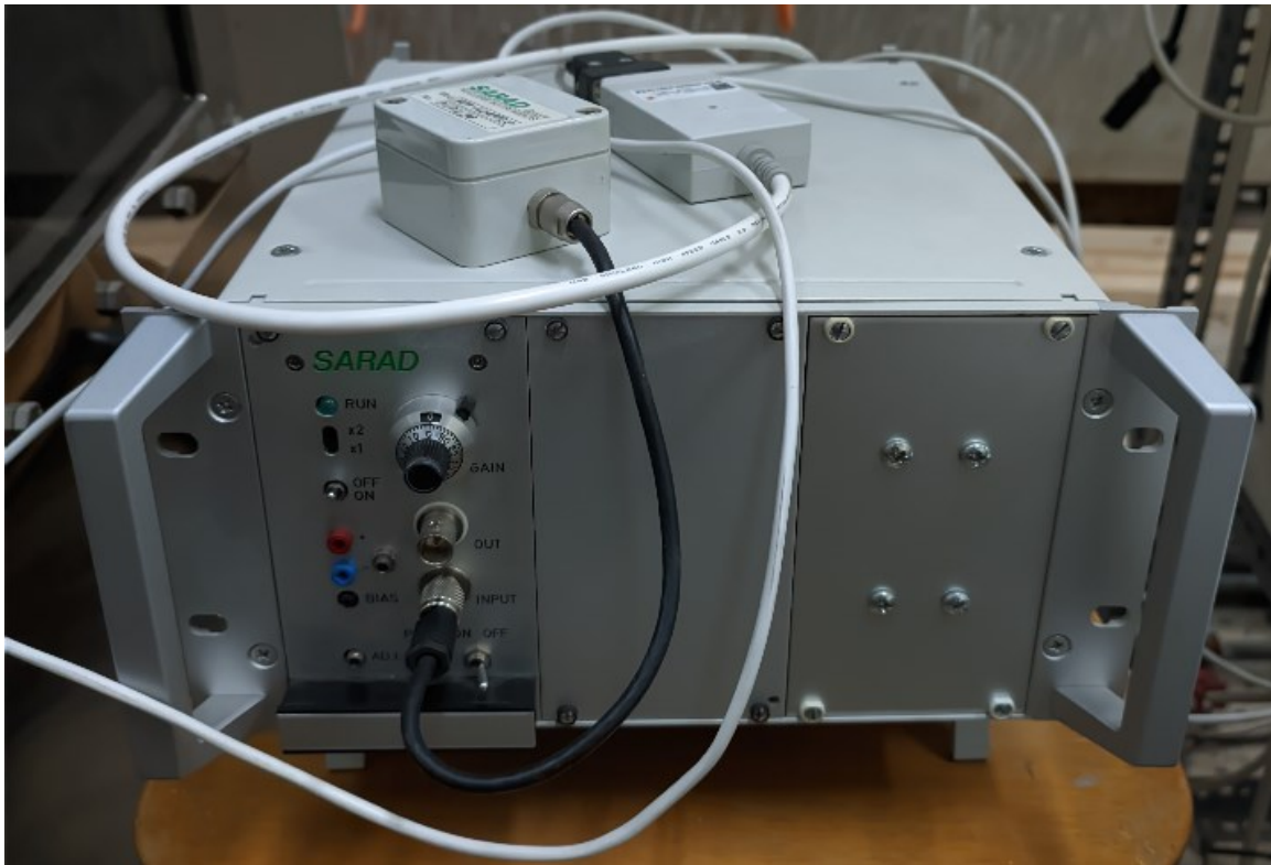
Εικ. 4.26 Πολυκαναλικός αναλυτής 50XX εταιρείας κατασκευής SARAD. Διακρίνεται το interface USB θύρας πρωτοκόλλου CAN-BUS.
