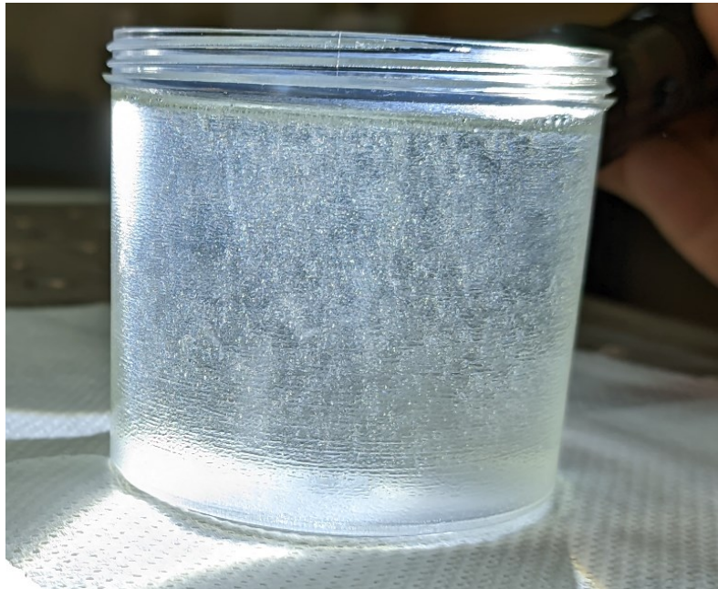
Εικ. 3.6 Παραμένουσες φυσαλίδες μετά από δόνηση στο πολυεποξικό S-86
