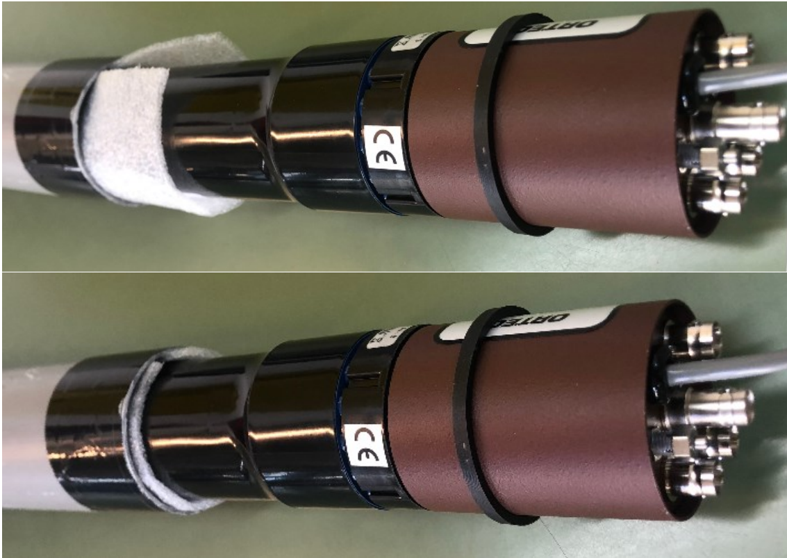
Εικόνα 4.17 Τοποθέτηση του συστήματος φωτοπολλαπλασιαστή - διαιρέτη τάσης - προενισχυτή στον σωλήνα PVC
