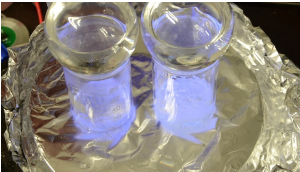
Εικ. 2.1 Προετοιμασία μείγματος ρητίνης-σκληρυντή-χειροποίητου κοκτέιλ για την κατασκευή κλασσικού σπινθηριστή
