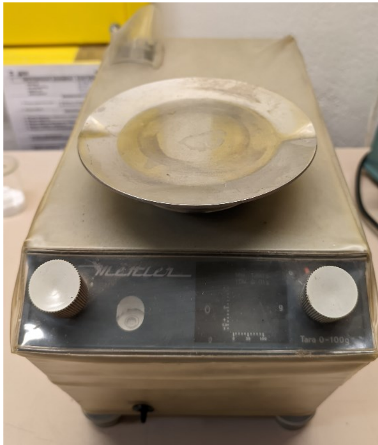
Εικ. 4.2 Εργαστηριακός ζυγός METTLER P-1200 ακρίβειας 0.01 g
