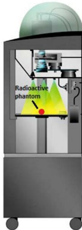
Εικόνα 12 : Το σύστημα απεικόνισης in vivo που έχει σχεδιαστεί ειδικά για οπτική απεικόνιση με χαμηλά επίπεδα φωτισμού σε μικρά ζώα. Αποτελείται από ένα μικρό χώρο με κάμερα CCD υψηλής ευαισθησίας με διαφορετικούς φακούς, φίλτρα και ειδικά φώτα. Στην περίπτωση μας δεν χρησιμοποιούμε τα φώτα.[18]
