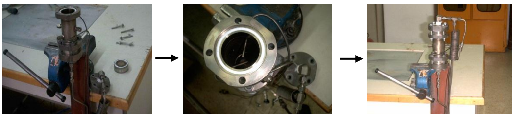
Εικόνα 5.4. Αντιδραστήρας μεταπολυμερισμού στερεάς κατάστασης κατά την προετοιμασία της πειραματικής δοκιμής
