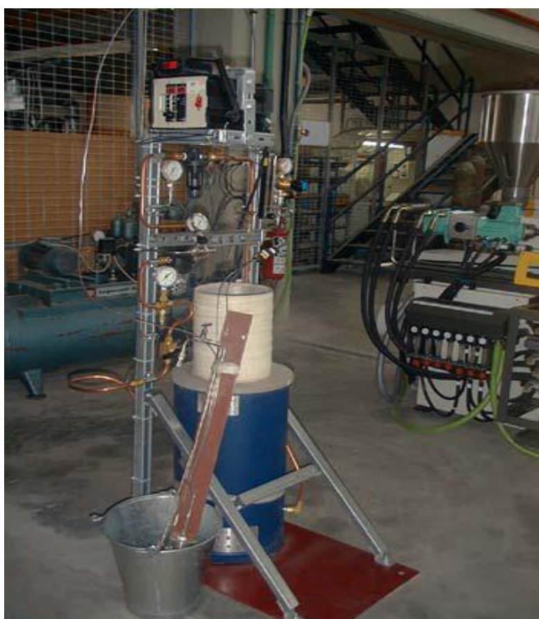
Εικόνα 5.1. Φωτογραφία διάταξης αντιδραστήρα μεταπολυμερισμού στερεάς κατάστασης στο Ημιβιομηχανικό Εργαστήριο της Σχολής Χημικών Μηχανικών (Ε.Μ.Π).
