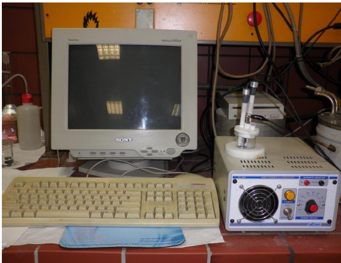
Εικόνα 8.1: Πειραματική διάταξη φωτοηλεκτροχημικού κελιού (PEC).[86]
