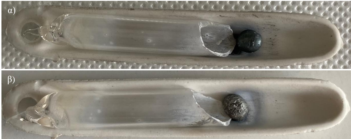
Εικόνα 39 Δείγμα GK1-002 α) πριν και β) μετά την διεξαγωγή του πειράματος
