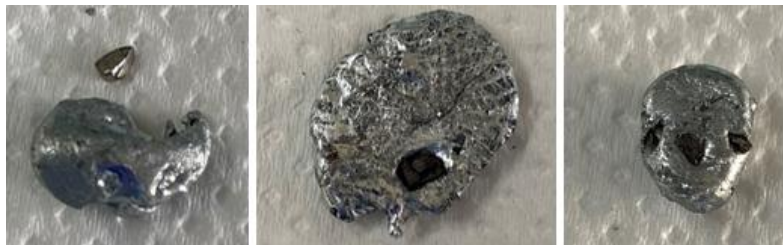
Εικόνα 30 Μέταλλα μετά το pre mixing στον επαγωγικό φούρνο
