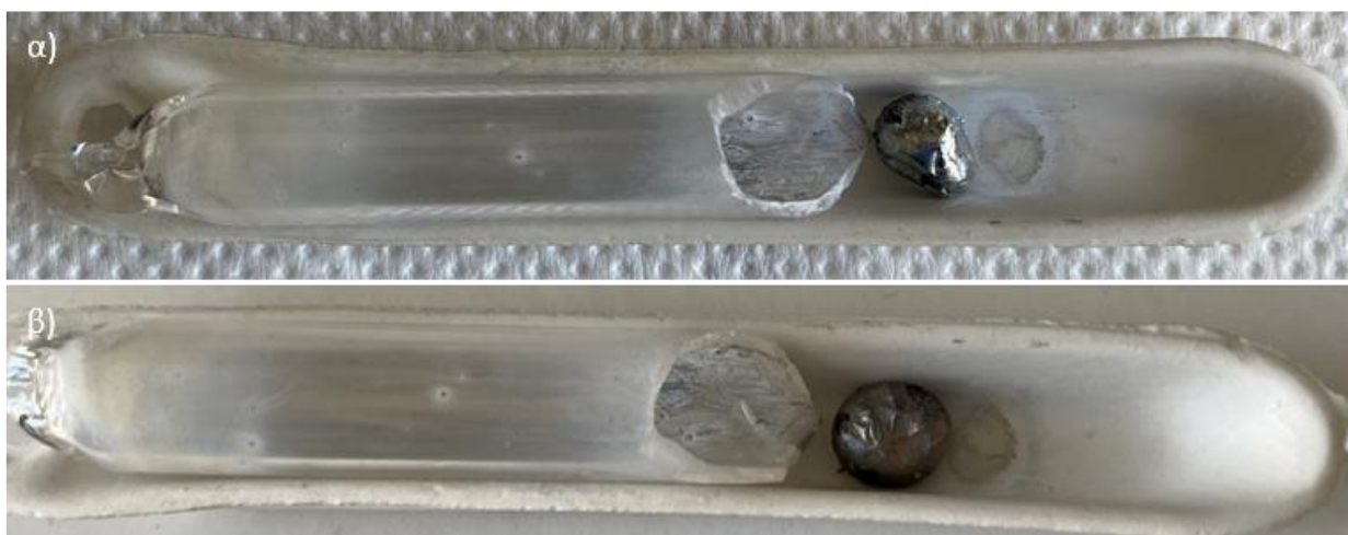
Εικόνα 41 Δείγμα GK1-006 α) πριν και β) μετά την διεξαγωγή του πειράματος
