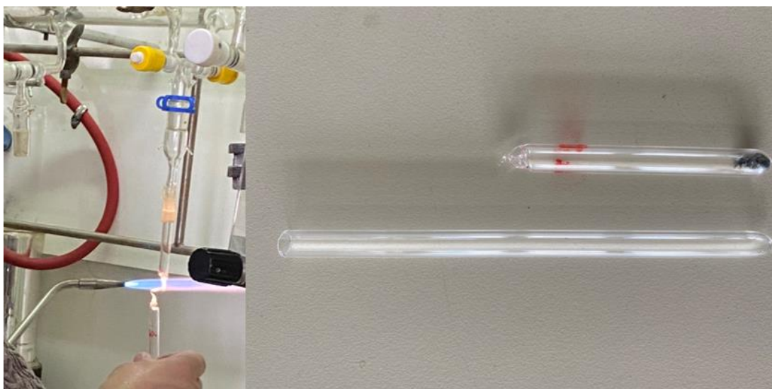
Εικόνα 33 Στεγανοποίηση της αμπούλας/ Πριν και μετά τη στεγανοποίηση
