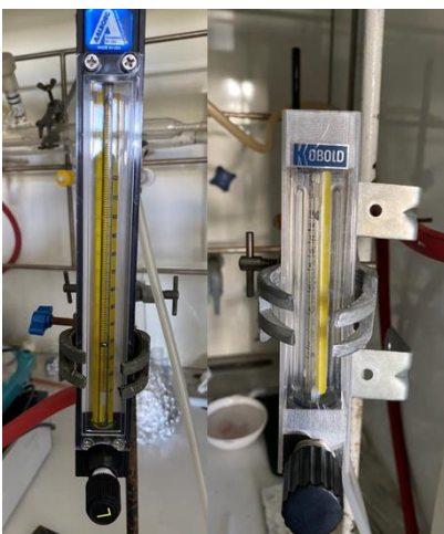
Εικόνα 24 Ροόμετρα αερίων: δεξιά μεθανίου/αριστερά αργού
