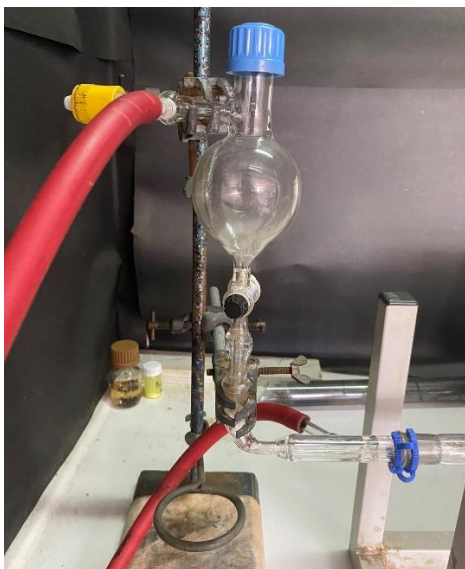
Εικόνα 23 Σύνδεση αερίων και ανάμιξη αερίων: Επάνω σύνδεση αργού, Κάτω σύνδεση μεθανίου
