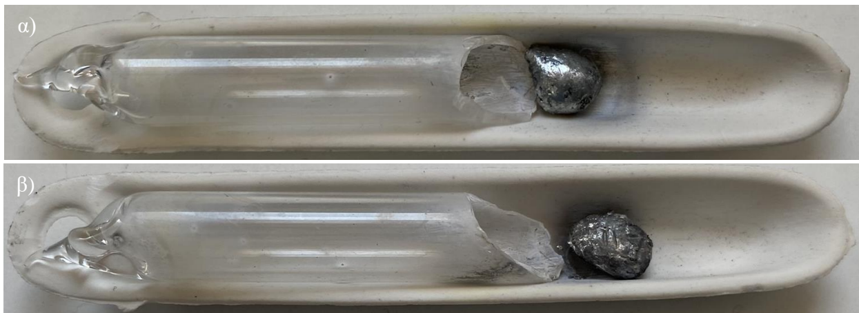
Εικόνα 51 Δείγμα GK1-008 α)πριν και β) μετά την διεξαγωγή του πειράματος
