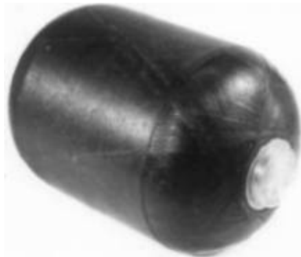
Σχήμα 2.18. Κέλυφος κατασκευασμένο από στρώση με φύλλα υπό γωνία.
