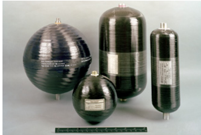
Σχήμα 2.2. Πιεστικά δοχεία κατασκευασμένα από σύνθετα υλικά
