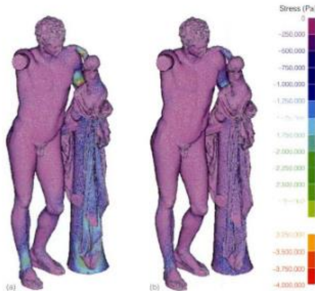
Εικόνα 4: Εικόνα από την ανάλυση με πεπερασμένα στοιχεία του αγάλματος Ερμή Πραξιτέλους [10]
