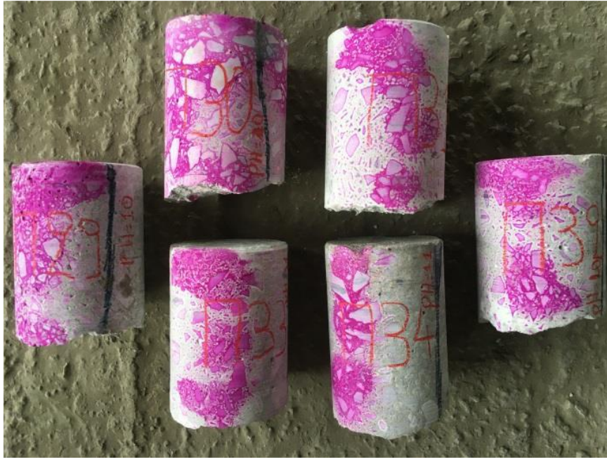
Σχήμα 2.6: Φωτογραφική απεικόνιση πυρήνων ύστερα από δοκιμή προσδιορισμού βάθους ενανθράκωσης. [21]
