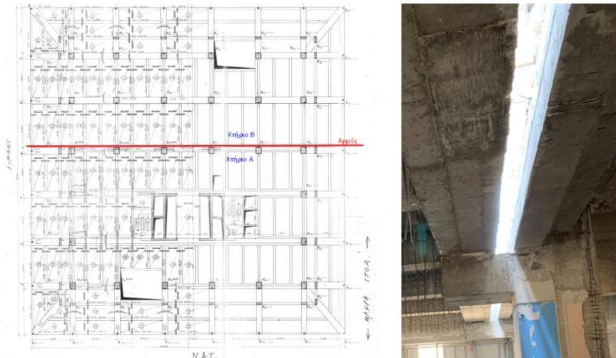
Σχήμα 1.1: Στα αριστερά, Δάπεδο Α' ορόφου, από τα επίσημα σχέδια. Το κτήριο Α διαχωρίζεται από το Β με τη χρήση αντισεισμικού αρμού, όπως φαίνεται στη δεξιά φωτογραφία (από προσωπικό αρχείο)
