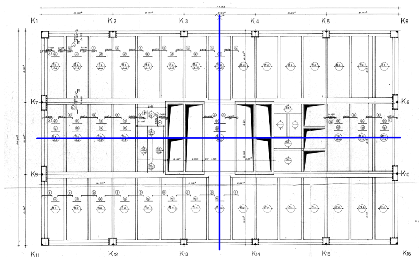
Σχήμα 2.8: Κάτοψη τυλικού ορόφου. Προφανής συμμετρία και στους δύο άξονες. (από επίσημα σχέδια)
