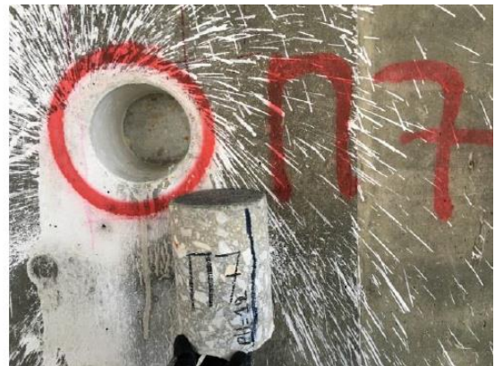
Σχήμα 2.5: Παράδειγμα λήψης πυρήνα από τοίχιο κλιμακοστασίου. [21]
