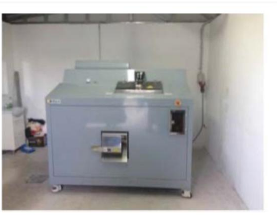
Εικόνα 36: Ξηραντήρας μονάδας επεξεργασίας [38]
