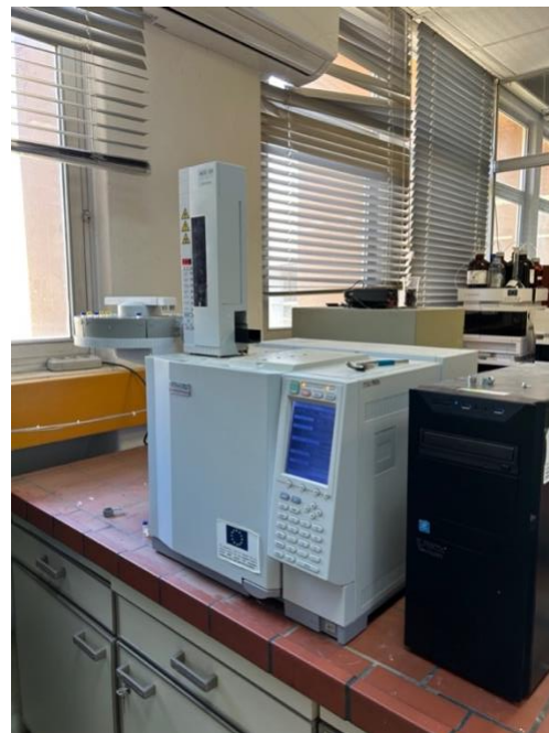
Εικόνα 25: Αέριος χρωματογράφος Shimadzu GC-2010 plus για μέτρηση πτητικών λιπαρών οξέων
