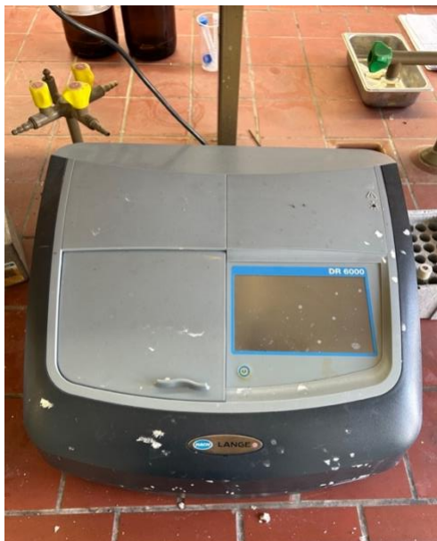
Εικόνα 24: Ηλεκτρονικό φωτόμετρο Hach Lange (DR2800) για τον προσδιορισμό του χημικά απαιτούμενου
