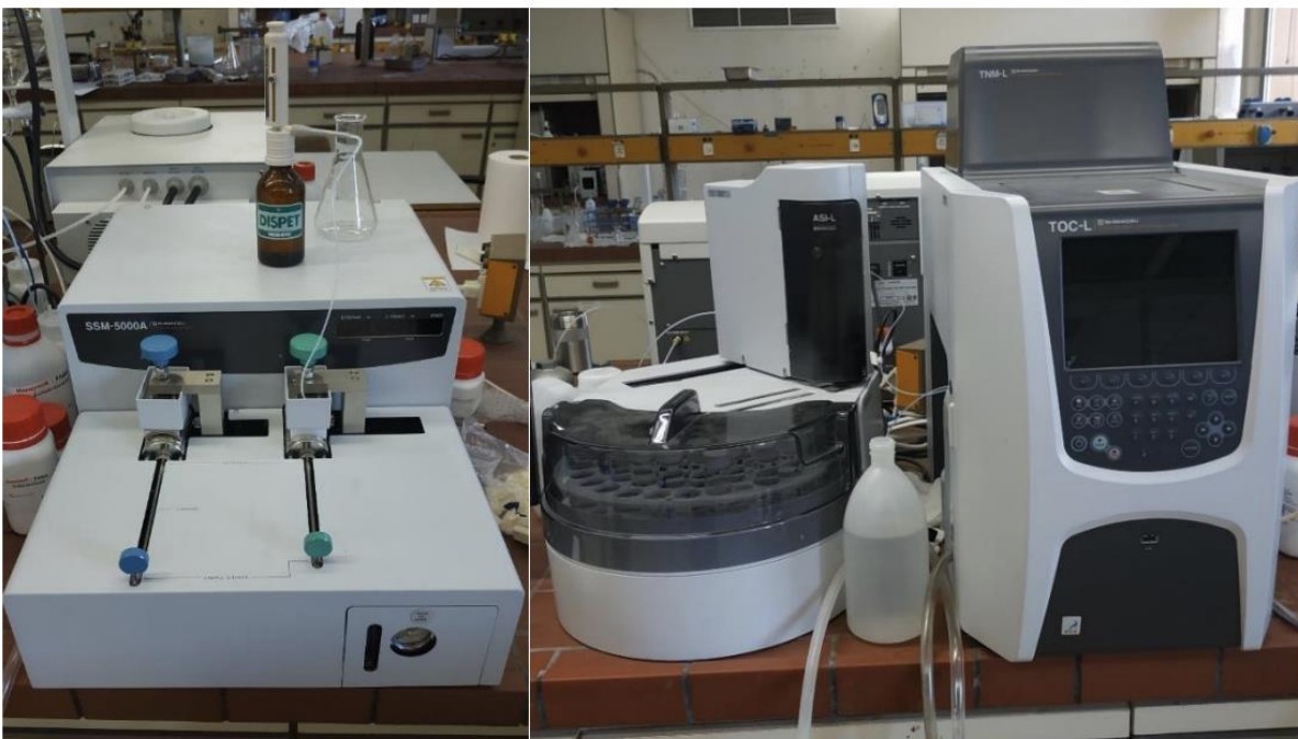
Εικόνα 28: Όργανο SHIMADZU SSM-5000A Solid Sample Module για τη μέτρηση του ολικού οργανικού άνθρακα (αριστερά) και Όργανο SHIMADZU TOC-L Total Organic Carbon Analyzer για τη μέτρηση του διαλυτού ολικού οργανικού άνθρακα (δεξιά) [37]
