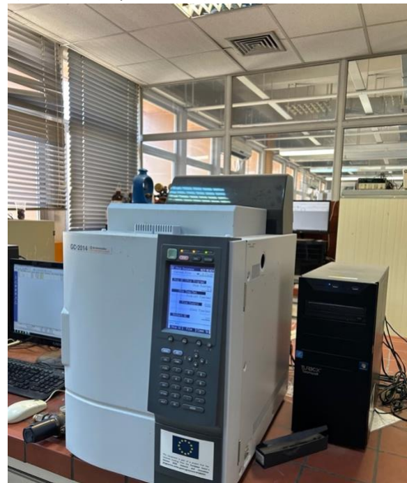
Εικόνα 26: Αέριος χρωματογράφος Shimadzu GC-2014 για τη μέτρηση της περιεκτικότητας του βιοαερίου σε μεθάνιο
