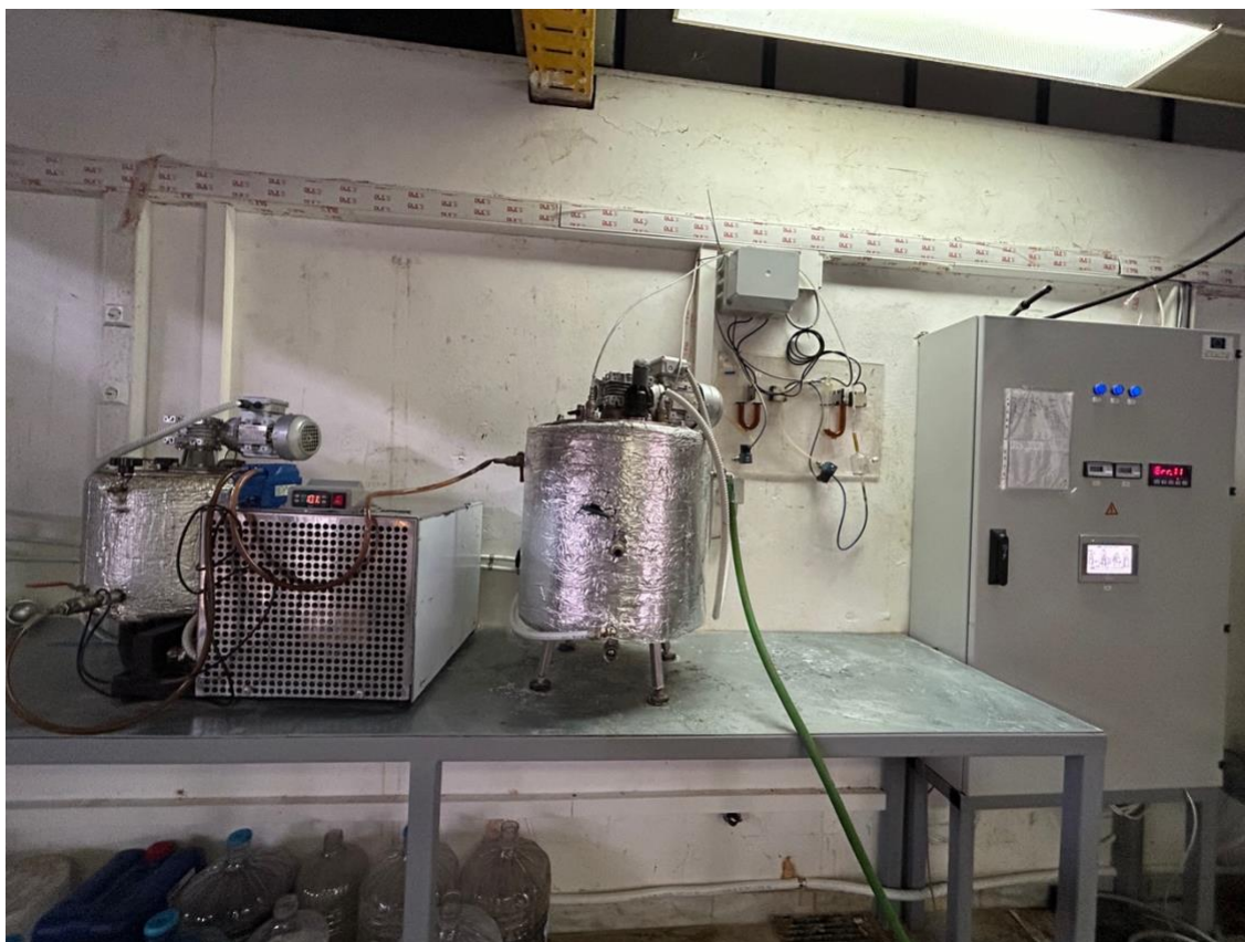
Εικόνα 33: Συνολικά διάταξη του συστήματος αναερόβιας χώνευσης στο ημιβιομηχανικό εργαστήριο της Σχολής Χημικών Μηχανικών
