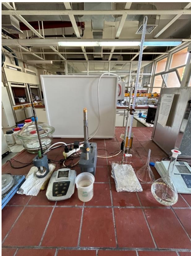
Εικόνα 23: Ηλεκτρονικό pH-μετρο πάγκου Sanxin PHS-3D-01 Lab pH Meter και διάταξη υπολογισμού
