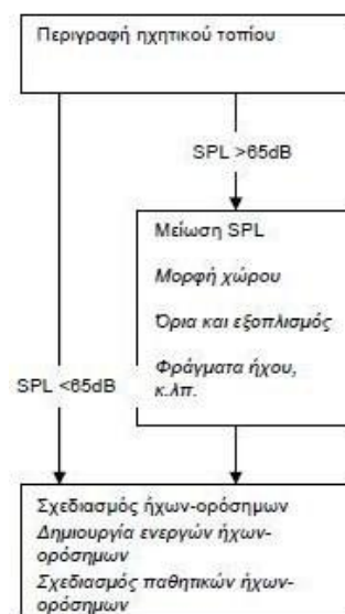
Σχήμα 1.23: Διαδικασία σχεδιασμού του ακουστικού τοπίου [Πηγή: Κέντρο Ανανεώσιμων Πηγών Ενέργειας (Κ.Α.Π.Ε.) (2004). Σχεδιασμός υπαίθριων αστικών χώρων με βιοκλιματικά κριτήρια].
